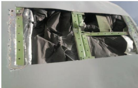
**Figura N° 56.-** Adecuación de área afectada en la sección delantera de la cabina.
