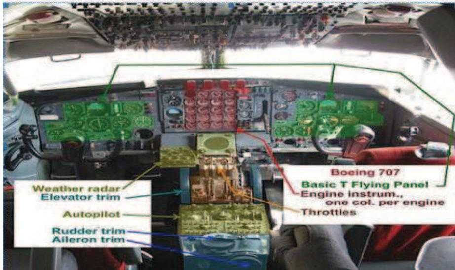
**Figura N° 12.-** Vista frontal de la cabina Boeing 707.
