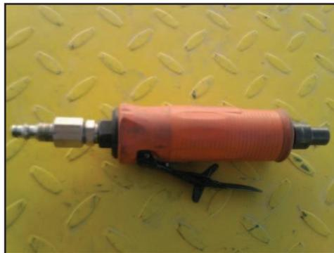
**Figura N° 21.-** Cortadora neumática manual.
