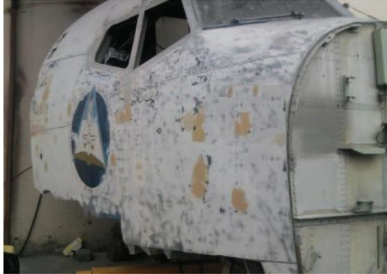
**Figura N° 69.**-Cabina del avión Boeing 707 macillada.
