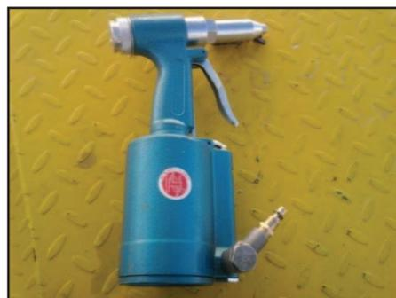
**Figura N° 28.-** Remachadora neumática.
