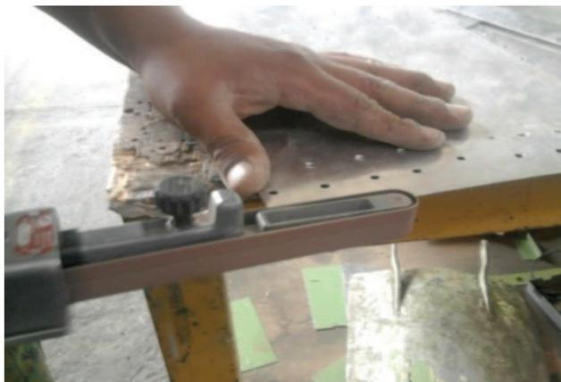
**Figura N° 62.-** Remoción del os filos cortantes de la láminas de aluminio.
