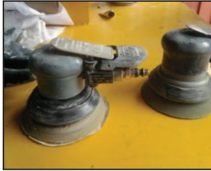
**Figura N° 24.-Lijadora orbital.**
