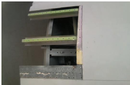
**Figura N° 57.-** Adecuación del área afectada en la sección posterior de la cabina.
