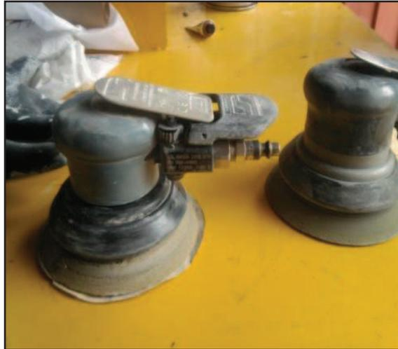
**Figura N° 39.-** Pulidora neumática.
