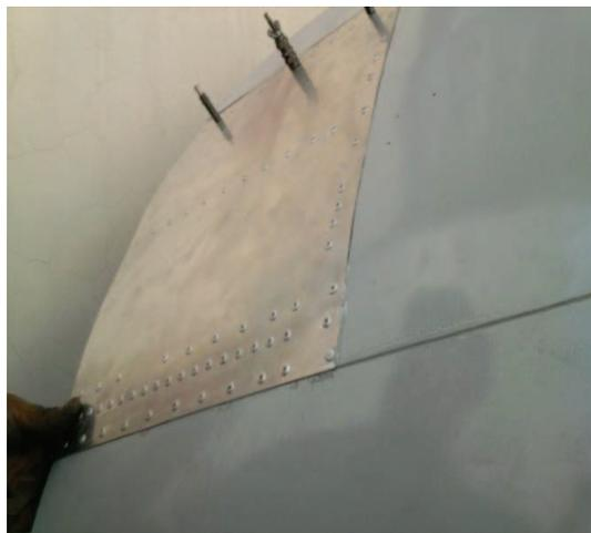
**Figura N° 63.**-Proceso de remachado de la lámina posterior.
