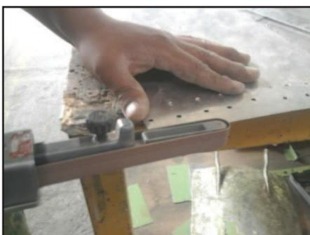
**Figura N° 23.-** Lijadoras neumática manual.
