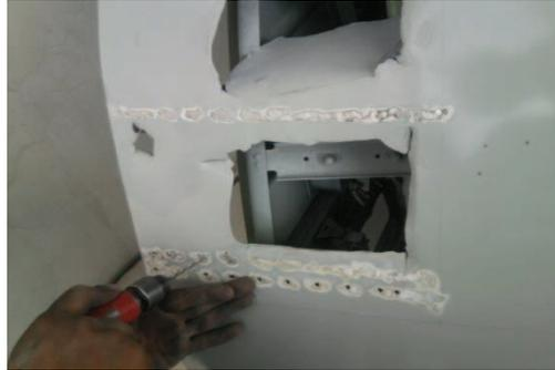
**Figura N° 55.-Retiro de las áreas dañadas en la sección posterior de la cabina.**
