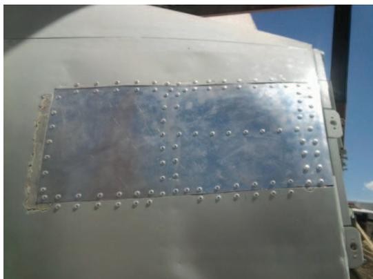
**Figura N° 65.**-Lámina de aluminio remachada en la sección delantera de la cabina.
