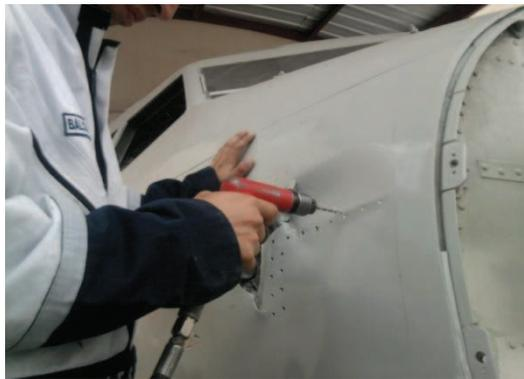
**Figura N° 53.-** Retiro de las áreas dañadas en la sección delantera de la cabina.
