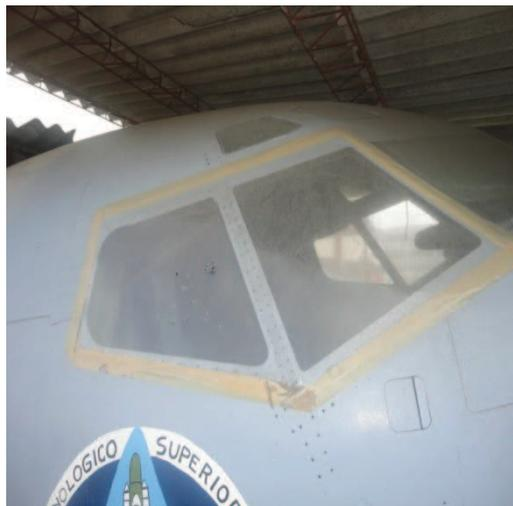
**Figuras 1.8.** Accesorios deteriorados de la cabina del avión Boeing 707.
