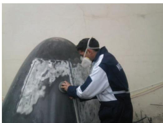
**Figura N° 68.**-Proceso de pulido del radomme de la cabina del avión Boeing 707.
