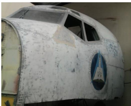
**Figura N° 67.**-Cabina del avión Boeing 707 pulida.
