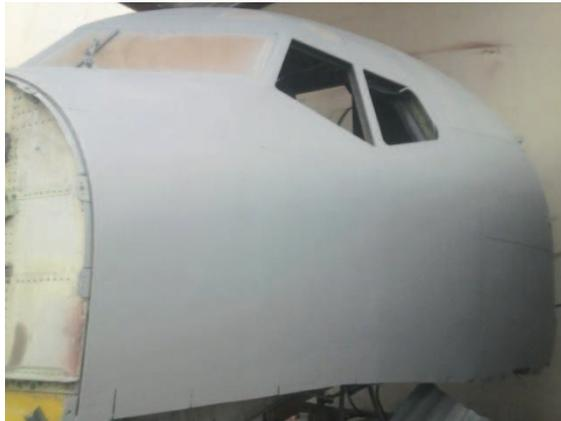
**Figura N° 70.**-Cabina del avión Boeing 707 fondeada.
