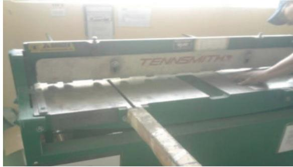
**Figura N° 59.-**Obtención de las dos láminas de aluminio para la reparación de la cabina.
