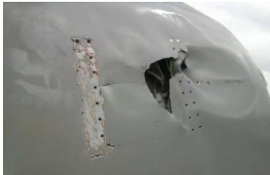
**Figura N° 54.-** Remaches retirados de las áreas dañadas en la sección delantera de la cabina.
