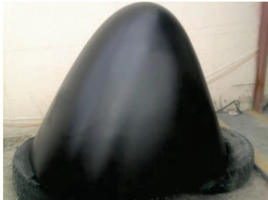
**Figura N° 74.-**Radomme de la cabina del avión Boeing 707 pintado.
