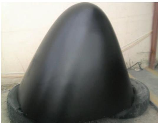
**Figura N° 71.-**Radome de la cabina del avión Boeing 707 pintado.
