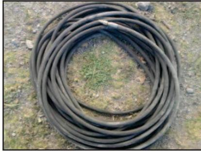
**Figura N° 41.-Manguera neumática.**
