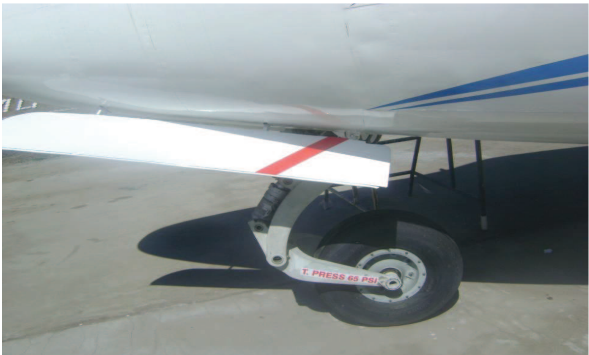
Figura 3.14: Zona de peligro tren de nariz lado izquierdo (Nueva señalética)
