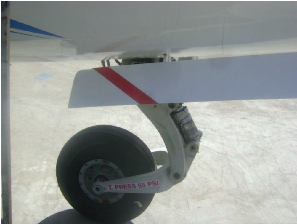
Figura 3.28: Zona de peligro tren de nariz lado derecho (Nueva señalética)
