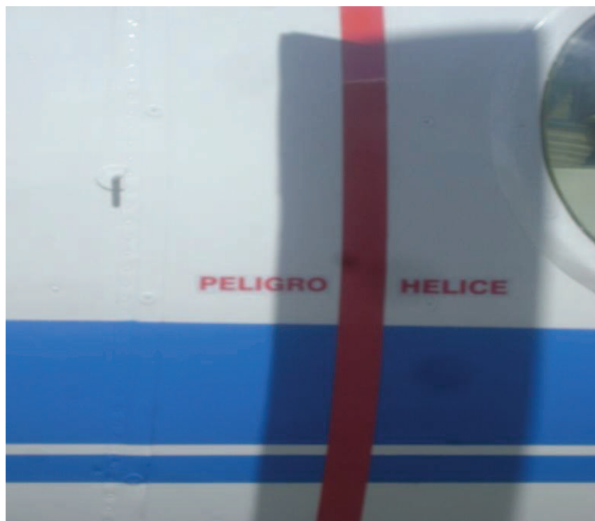
Figura 3.16: Zona de peligro hélice lado izquierdo (Nueva señalética)
