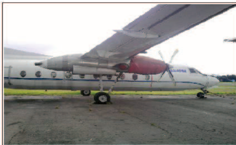
Figura 2.4.- Avión F-227J Motor, Alas, Trenes y Hélices
