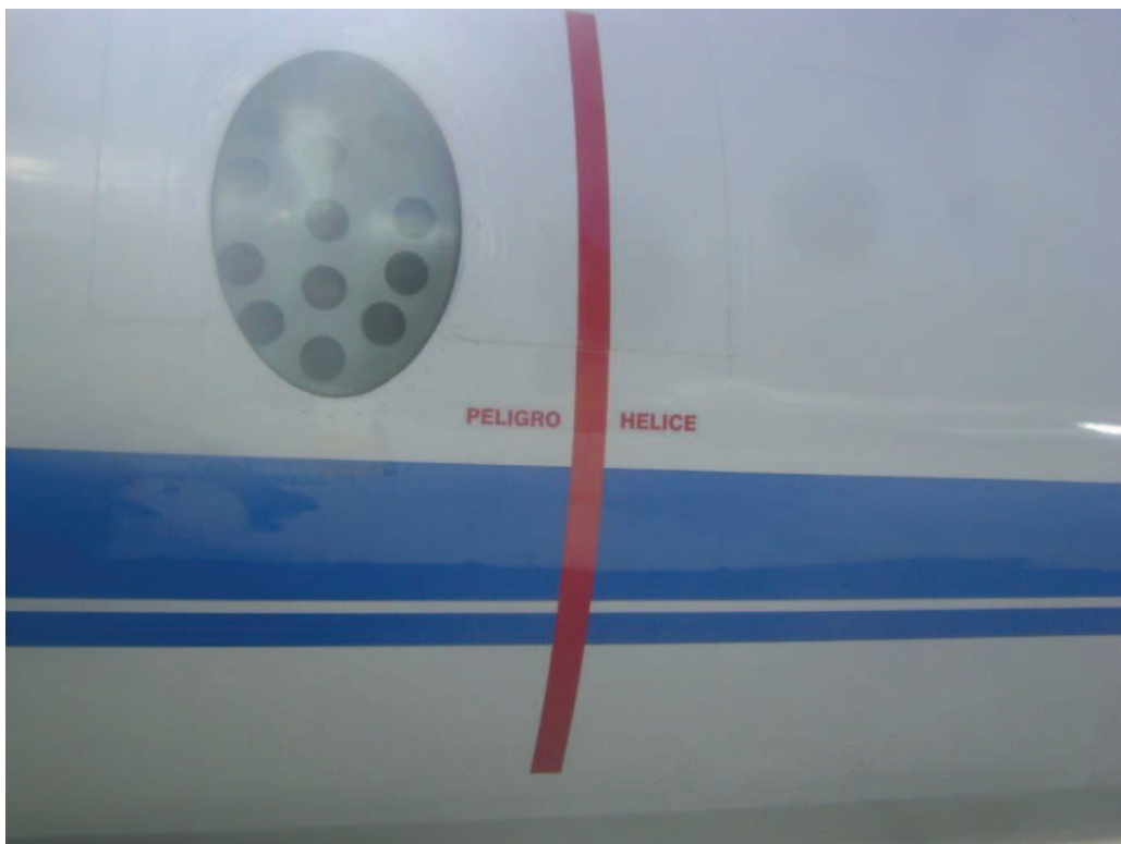
Figura 3.26: Zona de peligro hélice lado derecho (Nueva señalética)
