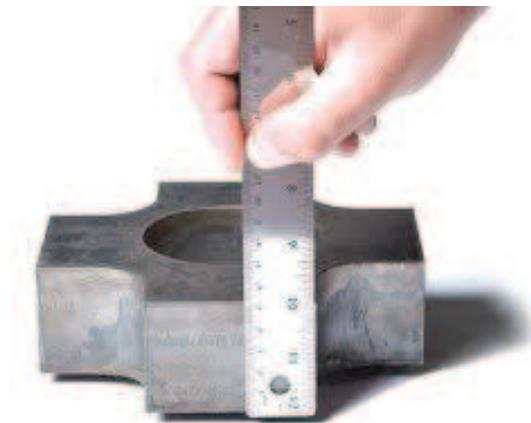
**Figura 2.23.** Regla metálica
