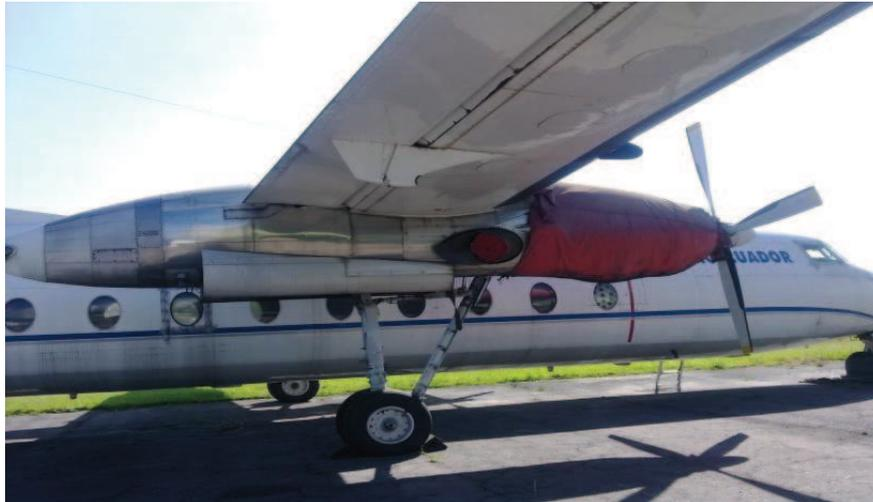
Como se observa en la figura, los motores están alojados en las alas además estos posan en sus trenes, las alas cuentan con sus perfiles aerodinámicos de control como: alerones, flaps, y se observa un detalle importante el cual no presentan corrosión, están en buen estado.
