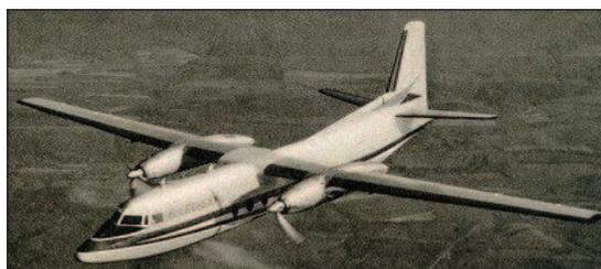
Los trabajos iniciales consisten en un alargamiento de la estructura del fuselaje, agregando un plug delante de las alas que aumenta su longitud en 1.98 m adicionales. Esto permite pasar de una capacidad de 40 pasajeros en los F.27 a 52 en los FH-227.
