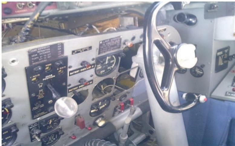
La cabina del avión está en perfectas condiciones y es totalmente completa ya que cuenta con todos sus paneles e instrumentos de navegación, equipos de radio, con sus dos cabrillas y asientos para el piloto y copiloto, adicional a esto no presenta fisura en el parabrisas.
