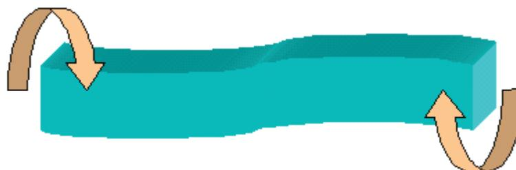
**Figura 2.10.** Esfuerzo de torsión
