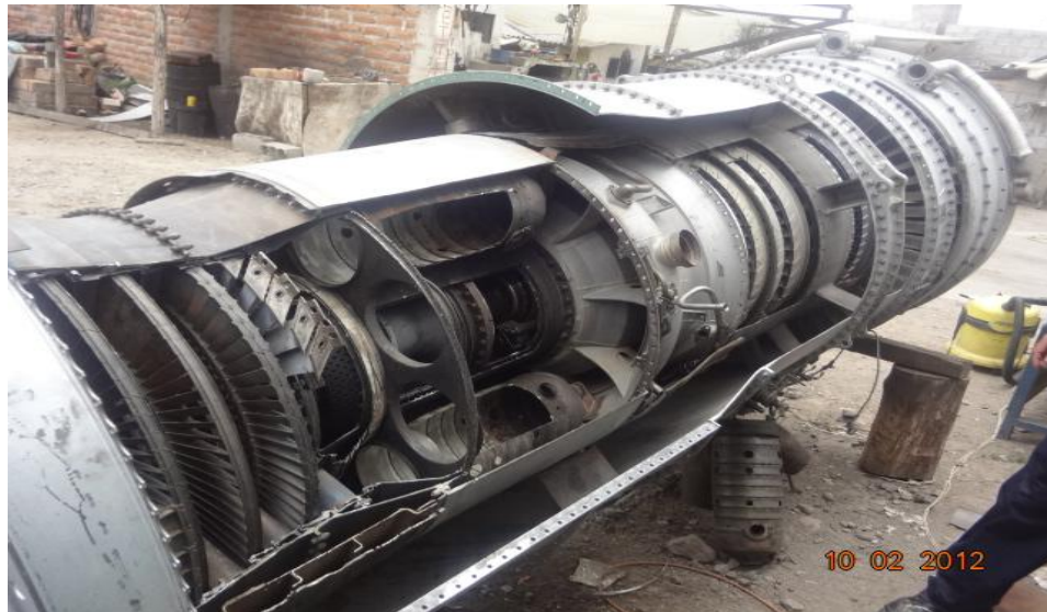
Figura 3.5 Motor JT8D-9A - Seccionado Elaborado por: Luís Romero
