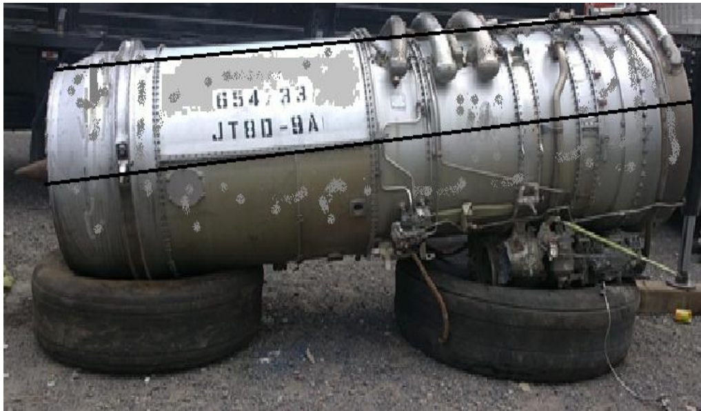
Figura 3.4 Motor JT8D-9A realizado trazos
