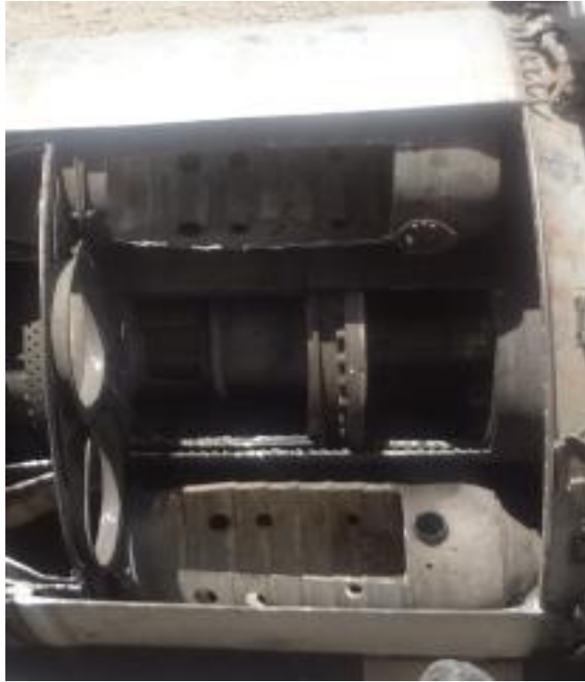
Figura 3.8 Seccionamiento de cámaras de combustión Elaborado por: Luis Romero
