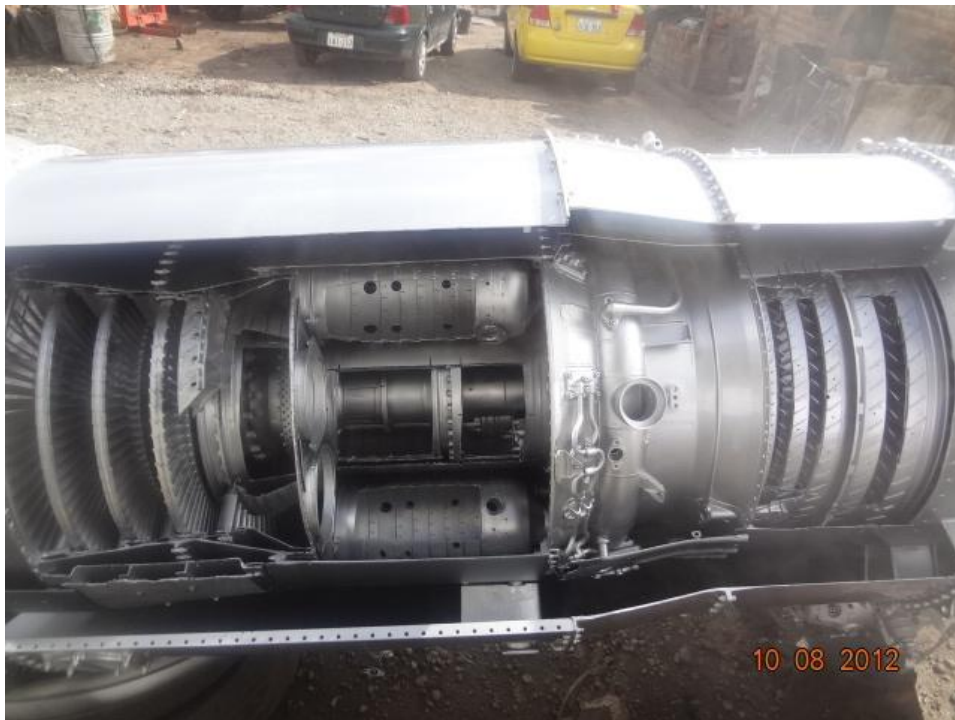
Figura 3.17 Pintado componentes fase final Elaborado por: Luis Romero
