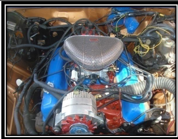
Figura 3.35.- Centrado del nuevo sistema de inyección Holley.
