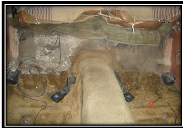
Figura 4.4 Piso Posterior Deteriorado.
