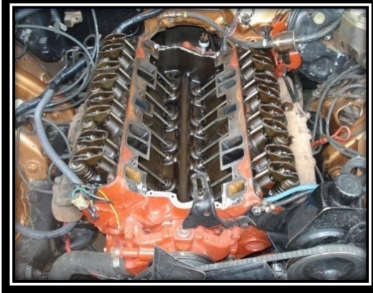
Figura 3.31.- Desarmado y limpieza del múltiple de admisión.
