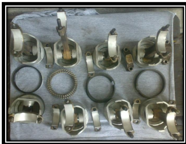
Figura 2.3.- Pistones Motor Chevrolet Monza 305.
