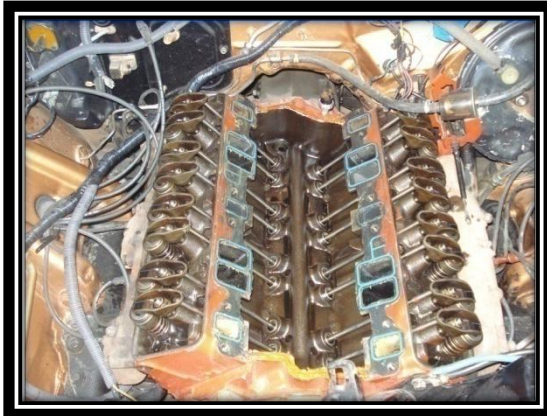
Figura 3.32.- Colocación de empaque de admisión.
