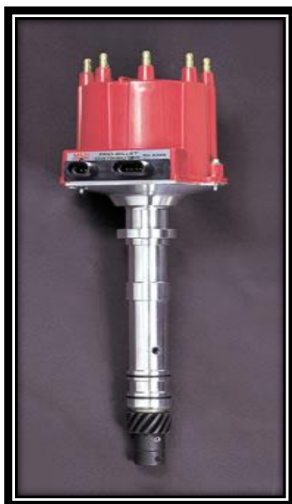
Figura 3.36.- Distribuidor MSD 8366 para Sistema Holley.
