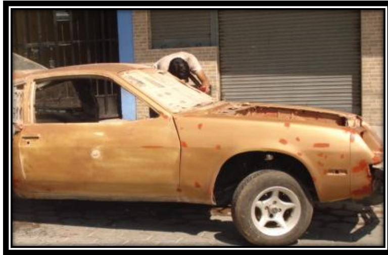
Figura 4.13.- Falla externas en la pintura.
