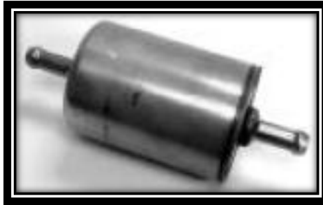
Figura 3.29.- Filtro de combustible.
