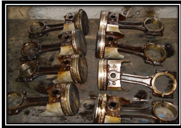
Figura 2.2.- Pistones Motor Chevrolet Monza 262.
