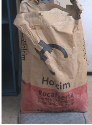
Fig. 3.6 Cemento utilizado en la construcción de la cubierta del compresor
