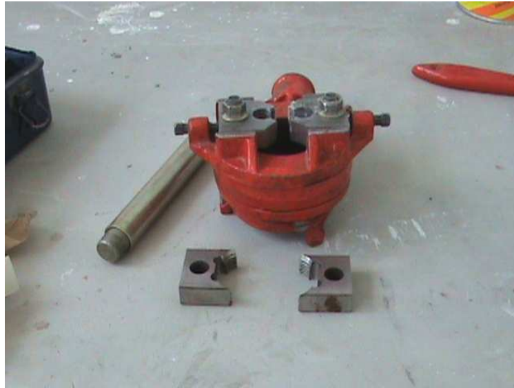
Terraja utilizada para abrir rosca en los tubos para el sistema neumático
