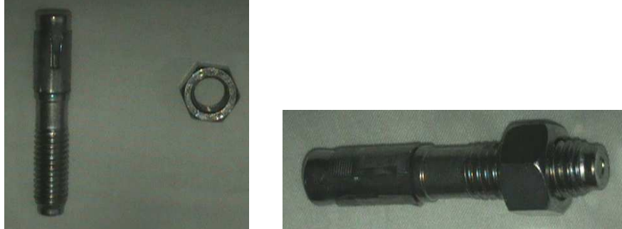
Fig. 3.4 Pernos expansivos utilizados para empotrar el compresor
