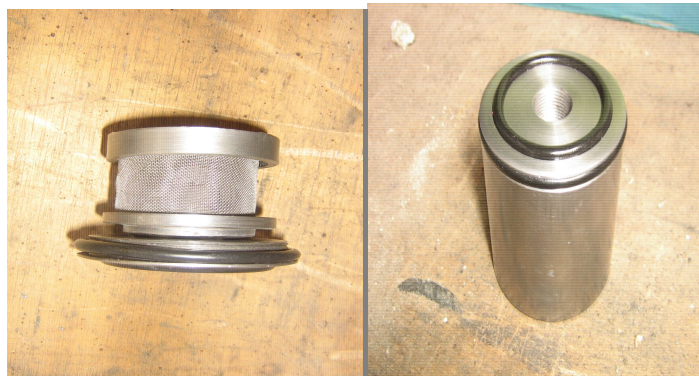
Fig.3.9 Malla del filtro y el filtro de purificación Realizado por: David Díaz Investigación: De campo
