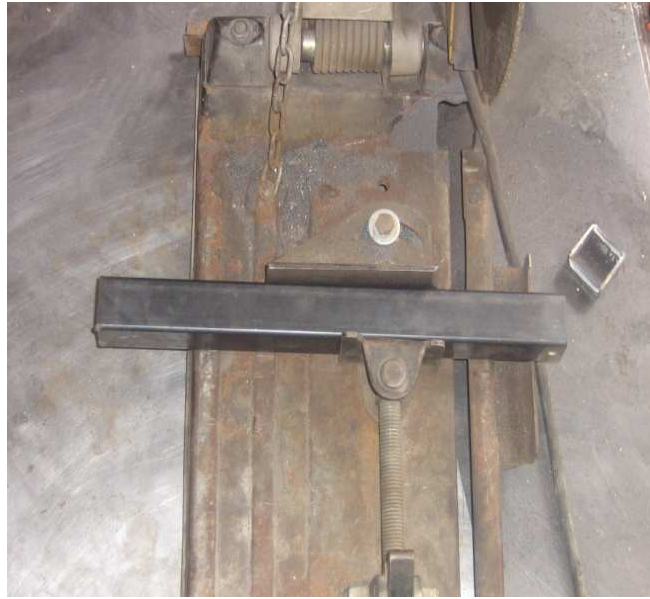
Fig.1 Tubo cuadrado de hierro reforzado de 40x40mm para la estructura Realizado por: David Díaz Investigación: De campo
