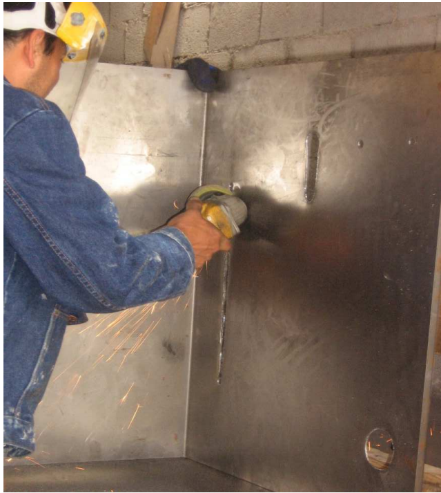
Fig.11 Plancha de tol fría, para el recubrimiento del banco hidráulico Realizado por: David Díaz Investigación: De campo
