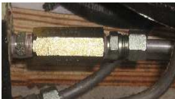
Fig. 2.34 Válvula check. Realizado por: David Díaz Investigación: De campo
