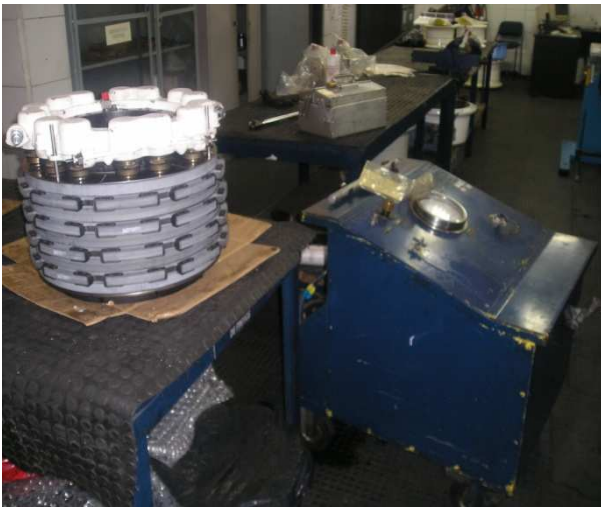
El Taller de Ruedas y Frenos, con el conjunto de frenos y el banco hidráulico (tester hidráulico).
