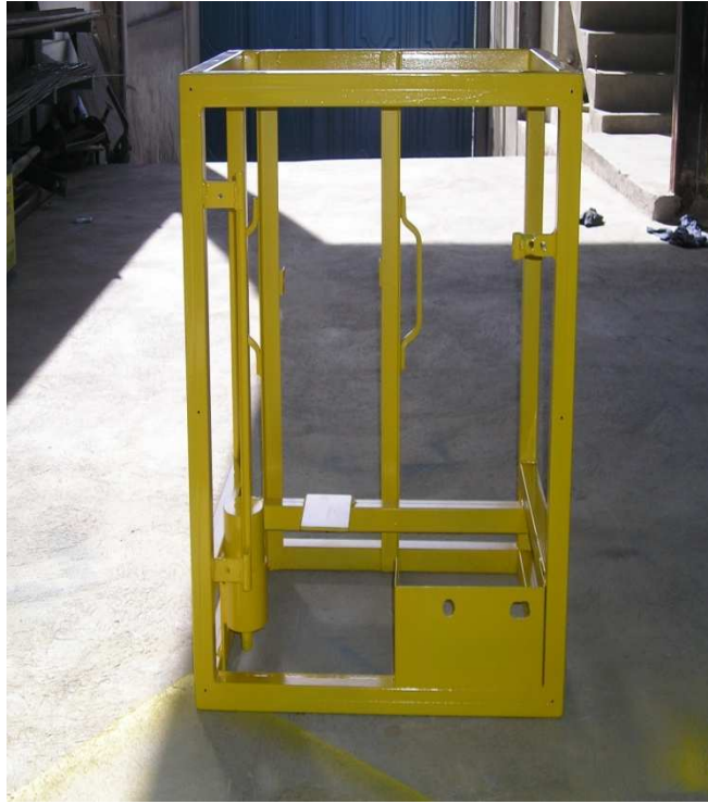
Fig.13 Estructura del banco hidráulico pintada Realizado por: David Díaz Investigación de: Campo
