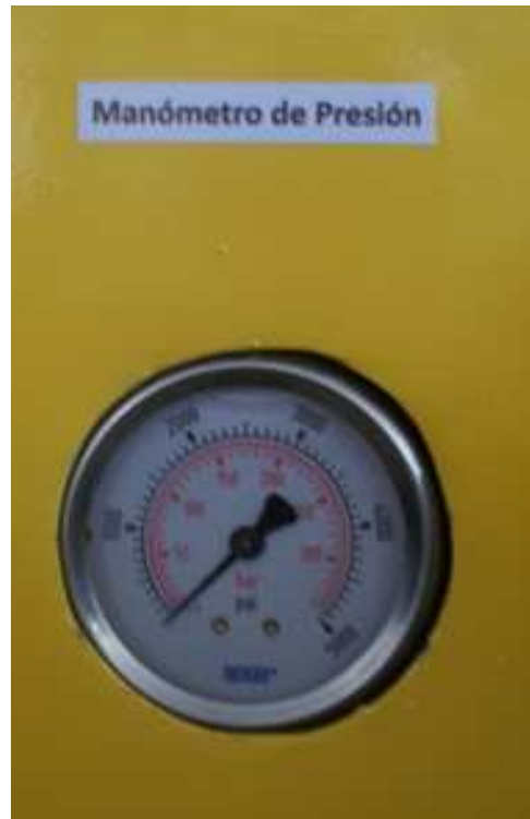
Fig.1 Manómetro de presión del Banco Hidráulico
