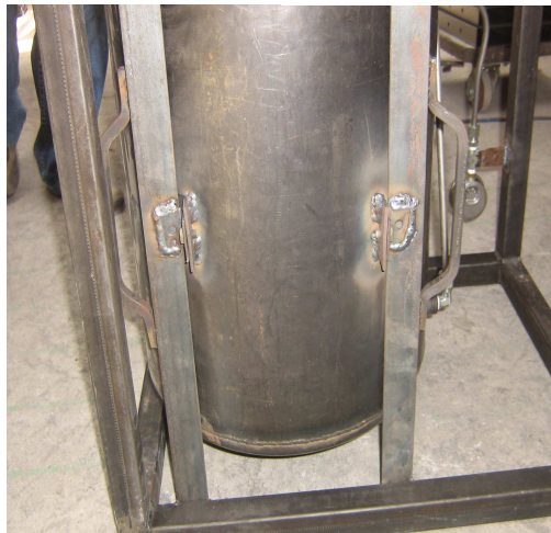
Fig.3.4 Las dos platinas con base y fijadas al depósito hidráulico Realizado por: David Díaz Investigación: De campo
