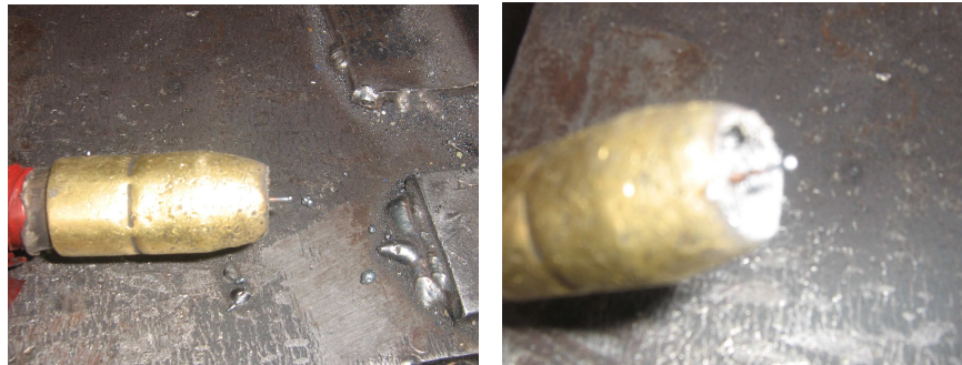
Fig. 2.25 Soldadura MIG con alambre 0.9mm Realizado por: David Díaz Investigación: De campo
