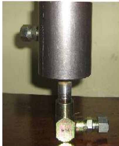
Fig.3.11 Cilindro de acero para el filtro, con sus 2 puertos Realizado por: David Díaz Investigación: De campo
