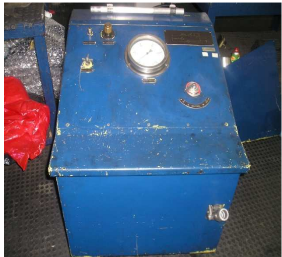
Banco hidráulico (tester hidráulico), parte externa.
