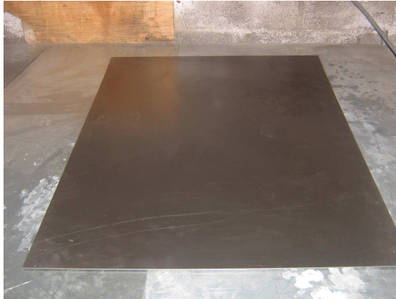
Fig. 2.31 Plancha de tol al frío de 1.4 mm Realizado por: David Díaz Investigación: De campo
