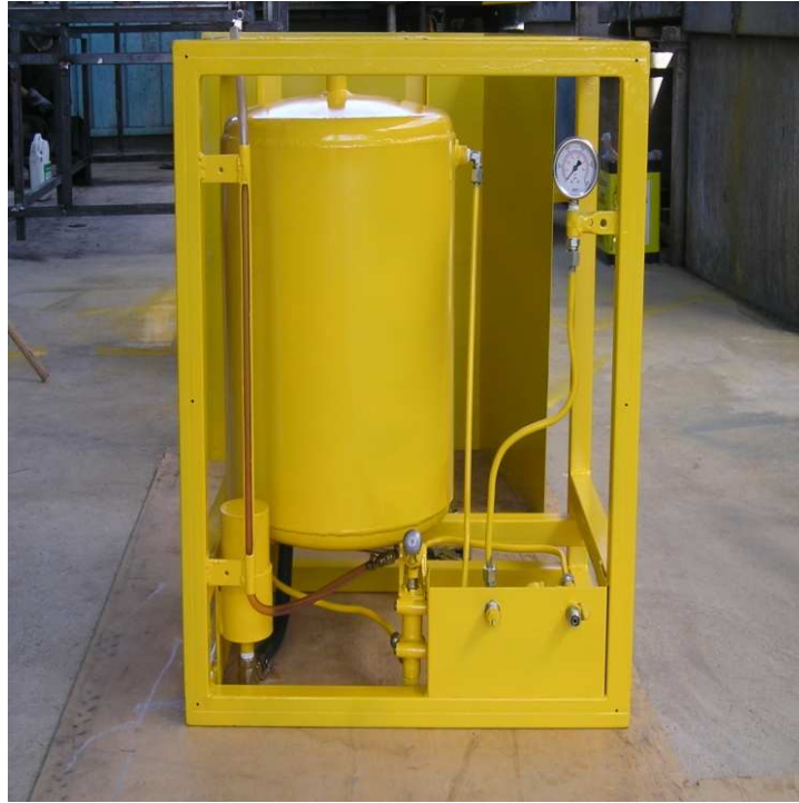
Fig.15 Banco hidráulico con todos los componentes instalados y pintados Realizado por: David Díaz Investigación de: Campo
