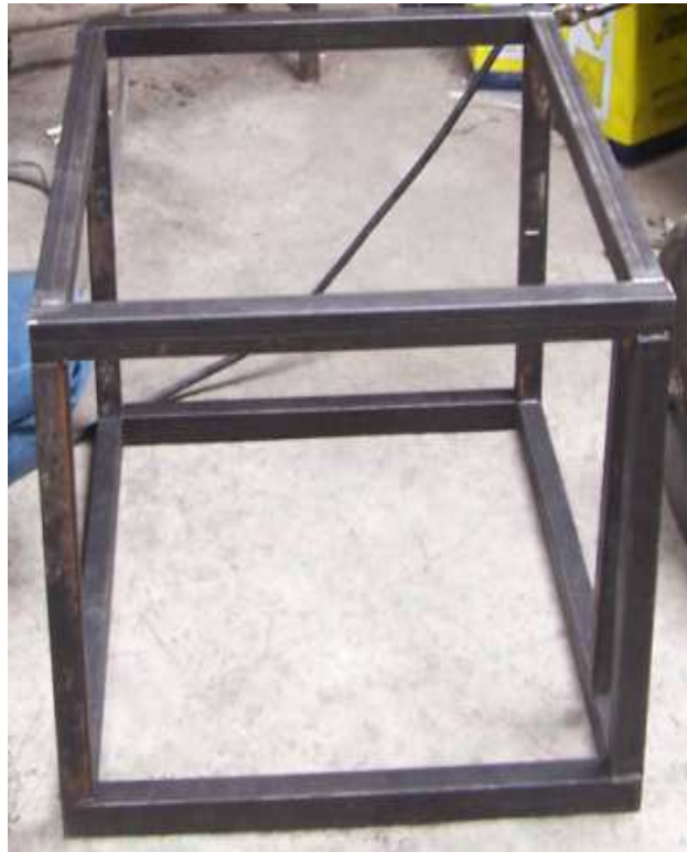
Fig.4 Formación de la estructura con el tubo cuadrado de hierro Realizado por: David Díaz Investigación: De campo
