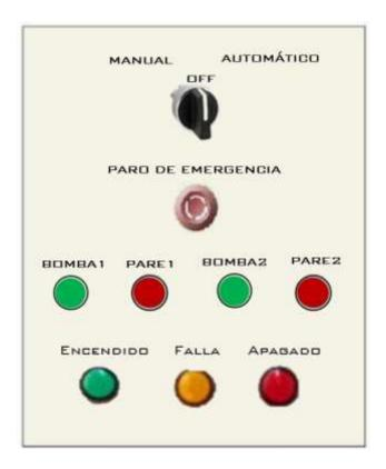
*Nota.* La imagen representa el diseño para la distribución de los dispositivos montados en el tablero metálico.
