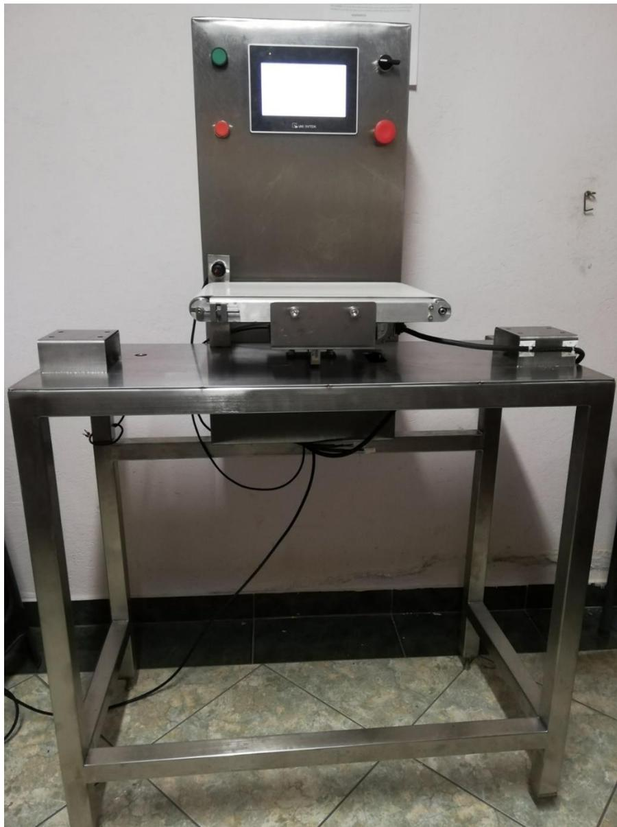
Posee además tres bandas transportadoras de 380mm de largo y 296mm de ancho, la cual ha sido construida en acero inoxidable y aluminio anodizado. Cada una de las bandas transportadoras posee una cinta de poliuretano de 0.8mm de espesor. Esto en correspondencia con la selección realizada en el apartado 3.1.1. (Ver Figura 96)
