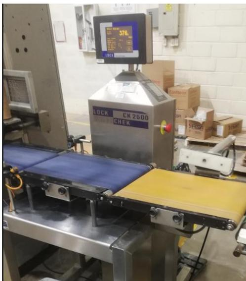
El checkweigher lleva en funcionamiento cerca de 10 años y sus prestaciones están limitadas para un único producto. Posee un cilindro neumático para implementar el sistema de rechazo de aquellos paquetes fuera de rango, el cual puede maltratar las cajas de los productos empaquetados. La tasa de muestreo es de 1 paq/s, siempre y cuando se trabaje bajo el producto especificado.
