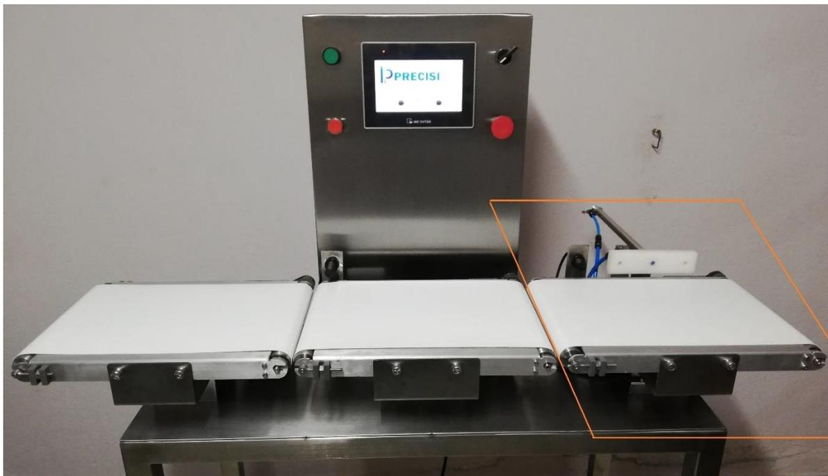
Culminando con la parte mecánica, en la Figura 98 podemos evidenciar el montaje del sistema de pesaje con una celda de carga de 18Kg de capacidad, haciendo uso de alzas en acero inoxidable de 31x90x6 [mm] tal y como recomienda el fabricante.
