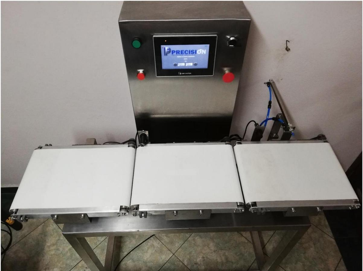
En lo que se refiere al sistema de rechazo, el checkweigher posee un cilindro neumático doble efecto con una carrera de 250mm accionado directamente por el controlador lógico cuando se cumple la condición preestablecida. El sistema total incluye; una electroválvula 5/2 monoestable de 24VDC, un FRL (filtro, regulador, lubricador), un cilindro neumático doble efecto y elementos de conexión. (Ver Figura 97)
