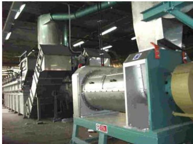
**Figura 2.13.-** Proceso de secado del PET reciclado.
