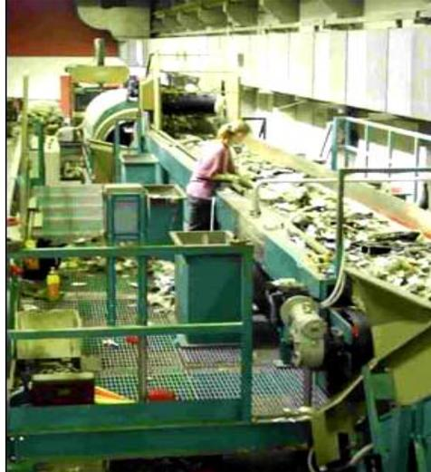
**Figura 2.12.-** Proceso de separación de PET para reciclaje.
