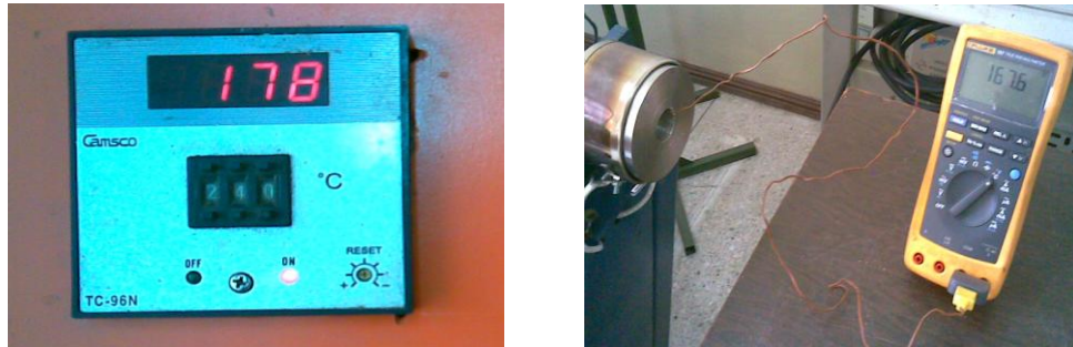
Figura 3.9.- Controles digitales y termocupla conectada a un multímetro.
