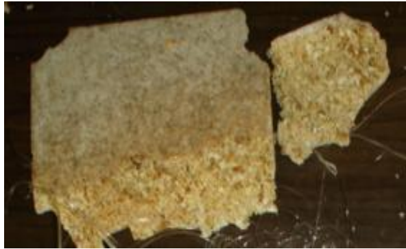
Figura 3.22.- Materia prima precalentada a excesiva temperatura.
