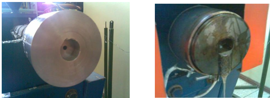
Figura 3.11.- Matriz de salida inadecuada para la obtención de fibras.
