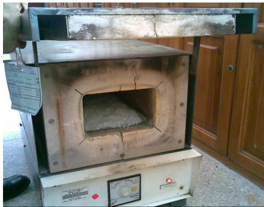
Figura 3.16.- Horno de mufla utilizado para el precalentamiento.
