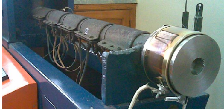
Figura 3.3.- Resistencias eléctricas en el cilindro y la matriz de extrusión.
