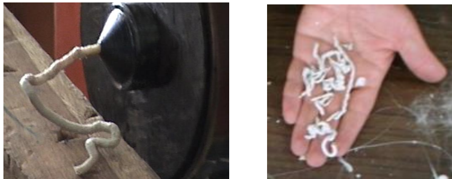
Figura 3.18.- Evacuación de material residual.
