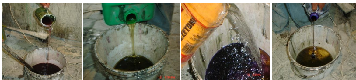
Figura 4.7.- Preparación de la resina poliéster con los diferentes aditivos.
