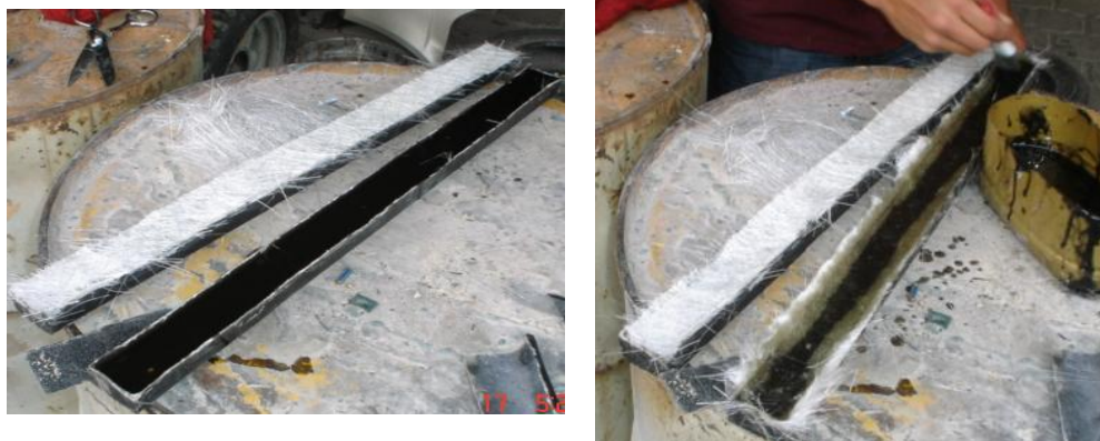
Figura 4.11.- Colocación de la última capa de fibra de vidrio en la probeta.
