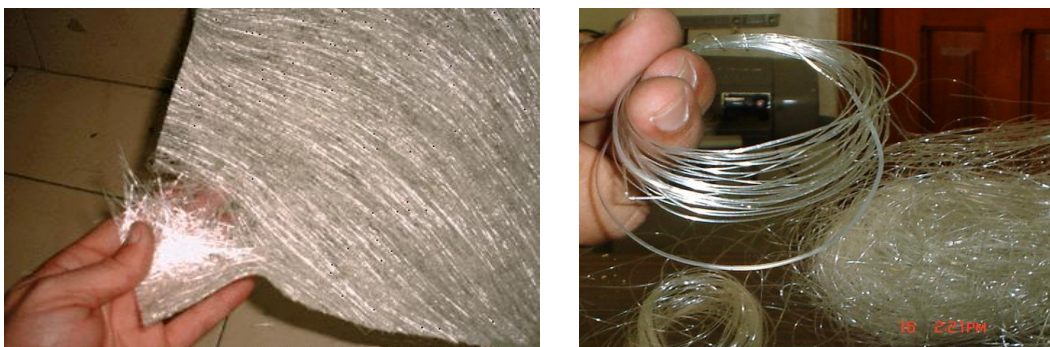
Figura 4.3.- Material de refuerzo de las probetas (fibra de vidrio, fibra de RPET).
