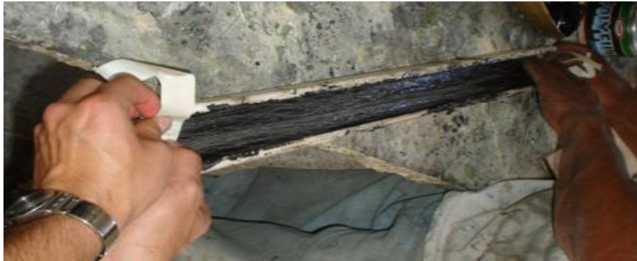
Figura 4.14 .- Fibras sujetas al molde antes de verter la resina.
