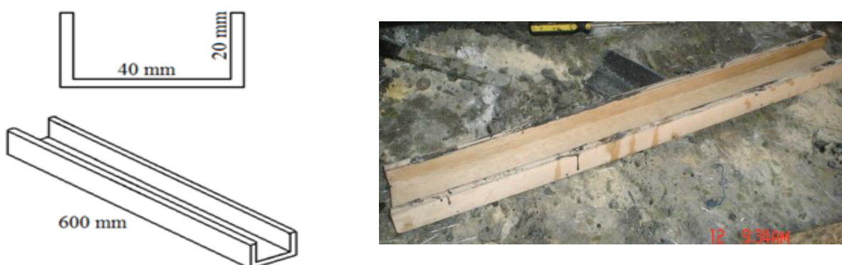
Figura 4.5.- Molde de tabla triplex para fabricación de probetas.
