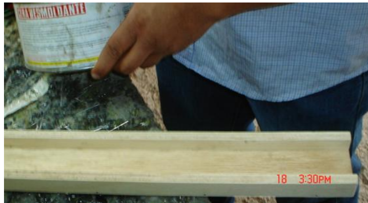
Figura 4.6.- Aplicación de cera desmoldante al molde de las probetas.
