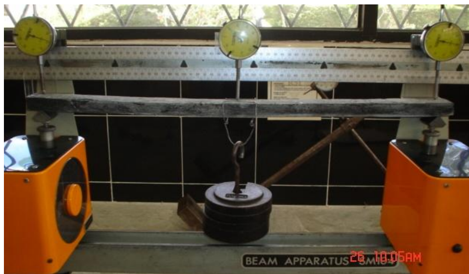
Figura 4.22.- Pesas utilizadas en el ensayo de flexión no destructivo.
