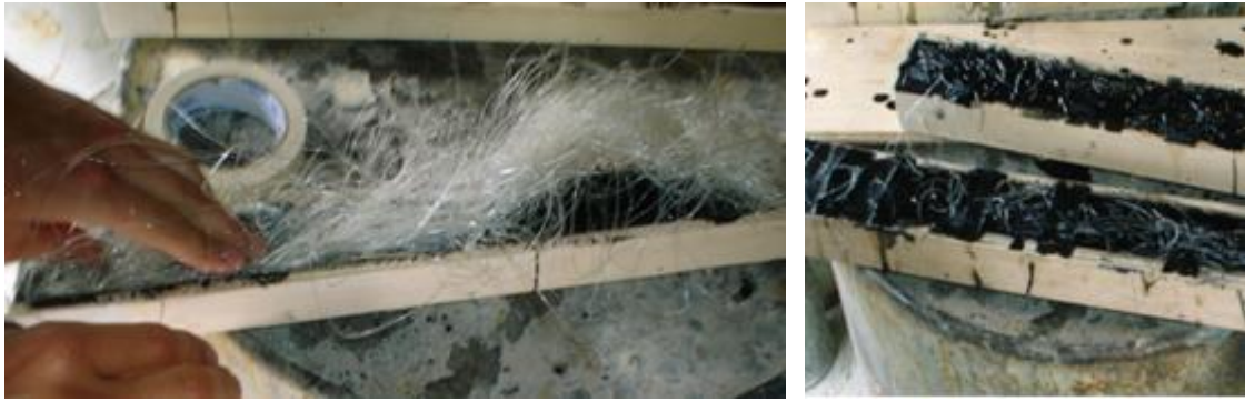
Figura 4.16.- Vertido de resina posterior a la ubicación de las fibras de RPET.
