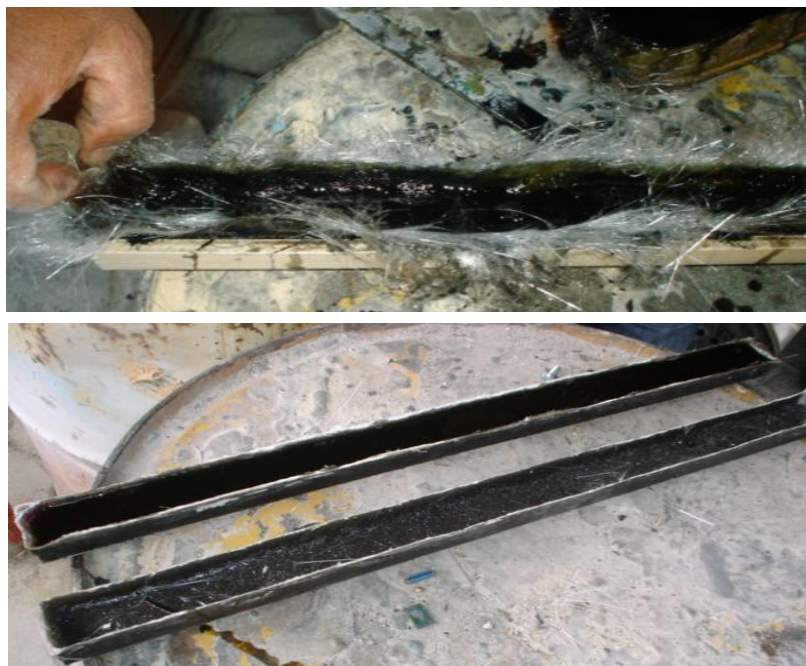
Figura 4.9.-. Probeta hueca desmoldada con una capa de fibra de vidrio.
