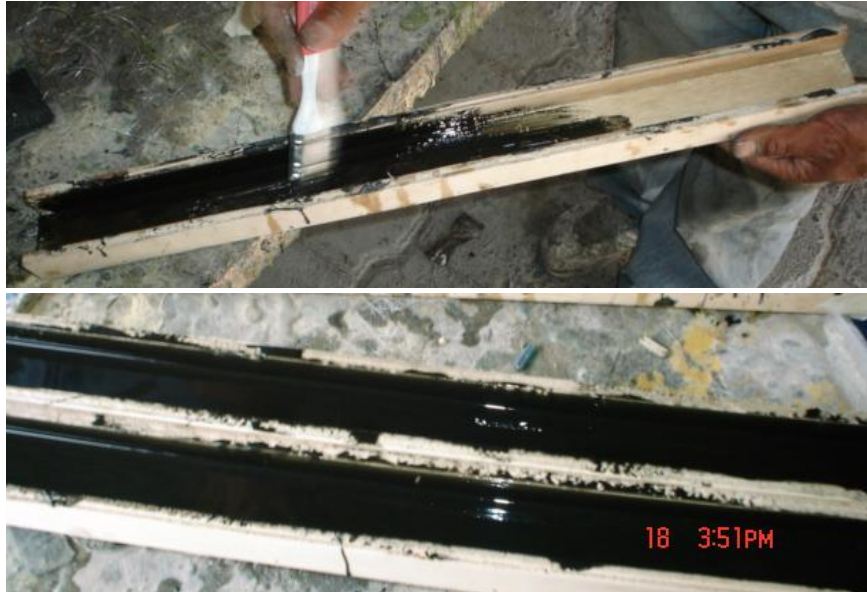
Figura 4.8.-. Primera capa de resina en los moldes.
