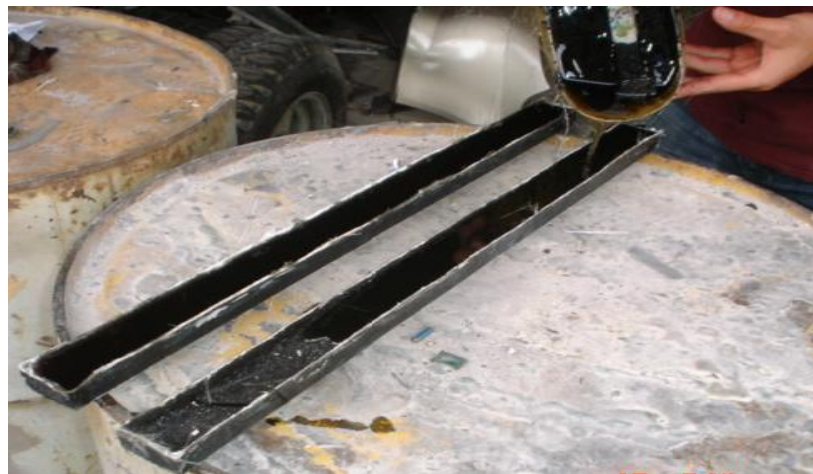
Figura 4.10.- Relleno de resina en las probetas de fibra de vidrio.
