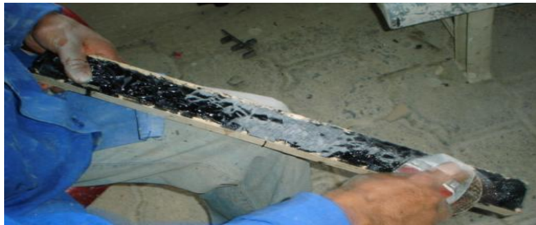
Figura 4.17.- Eliminación de rebabas en probetas de RPET.
