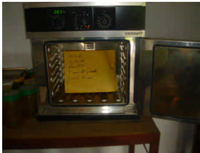
FOTO 17 Material vegetal en funda de papel sellado secado en estufa para determinar PMS.
