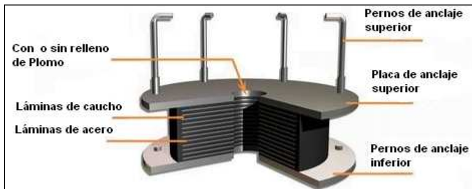
Figura 3.1 Detalle de un aislador elastomérico.
