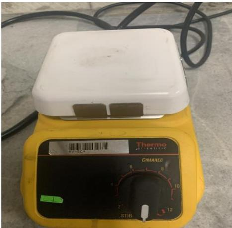
**Agitadores.** Con la finalidad de obtener una solución homogénea se utilizó un agitador en cada frasco de la solución polimérica, durante las 12 horas que duró el proceso de mezcla de la solución a temperatura ambiente hasta que esté totalmente homogeneizada.
