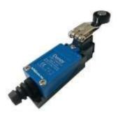
Nota. Se aprecia un fin de carrera, este es utilizado como contactos abiertos o cerrados, en este trabajo se lo utiliza como controlador de un siclo de funcionamiento de la prensa y como accionado del relé de tiempo que se utiliza como medida de protección para que el pistón no baje de inmediato protegiendo al operador en caso de haber doble golpe.
