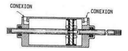
Nota. En la figura 5 podemos apreciar cómo está compuesto un cilindro de doble efecto.
