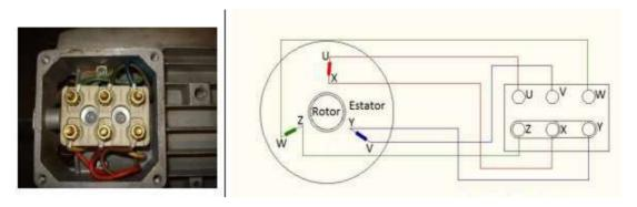
Nota. En la imagen superior podemos apreciar la conexión de un motor de "Jaula de Ardilla"
