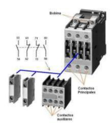
Nota. Se ilustra un bloque auxiliar con 1 contacto NC y NO, pero estos también vienen en presentación de 2 contactos NC y NO, en caso de que sea necesario accionar más dispositivos de manera simultánea cuando se accione el contactor (Ramírez, 2017).
