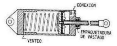
*Nota.* El cilindro de doble efecto. Esta configuración es deseable cuando se necesita que el desplazamiento volumétrico o la fuerza sean iguales en ambos sentidos.
