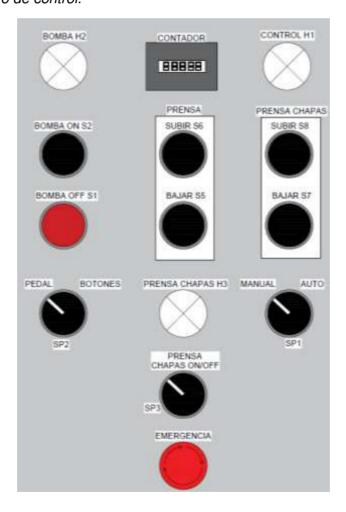
Nota. Distribución de los elementos de maniobra en la tapa del tablero de control.
