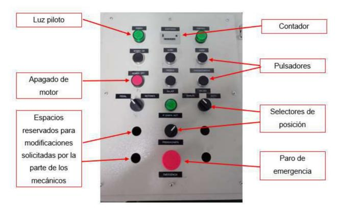
Nota. Finalmente, este tablero es el que controla todo el funcionamiento de la prensa de 1000 toneladas mediante este se acciona el pistón de la prensa y del presachapas también controla el movimiento de subida y de bajada de los vástagos de los pistones mediante el accionamiento de las válvulas y los contactores.
