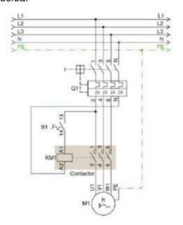
Nota. El circuito de fuerza es el encargado de alimentar al receptor (motor, calefacción, electrofreno, iluminació, etc). Está compuesto por el contactor (identificado con la letra K), elementos de protección (identificado con la letra F como pueden ser los fusibles, relé térmico, relés magnetotérmicos, etc) y un interruptor magnetotérmico identificado con la letra Q. Tomado de (Vaello Sancho, s.f.).
