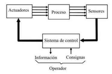
Nota. En la figura 10, se observa la estructura de un sistema automatizado.
