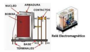
Nota. El relé brinda una ventaja esencial a la hora de implementar un tablero de control, esta radica en que gracias a la separación eléctrica que existe entre la corriente que acciona la bobina y la corriente de los contactos, se puede trabajar con altas tensiones y corrientes, aunque se tenga tensiones pequeñas en la bobina (Ramírez, 2017).
