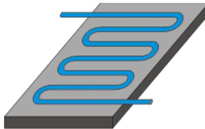
**Figura 4.12** Colector de serpentín.
