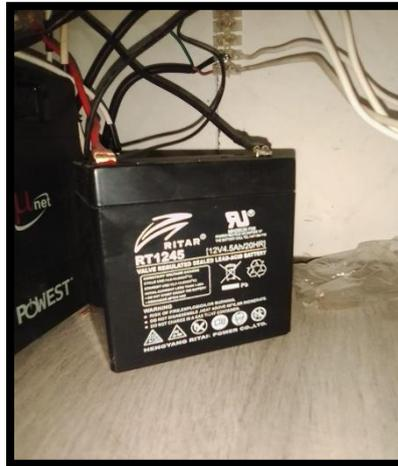
*Nota.* Cabe mencionar que una de las baterías se encuentra de forma interna en la UPS el cual fue modificado para realizar las conexiones en serie ya mencionados anteriormente.
