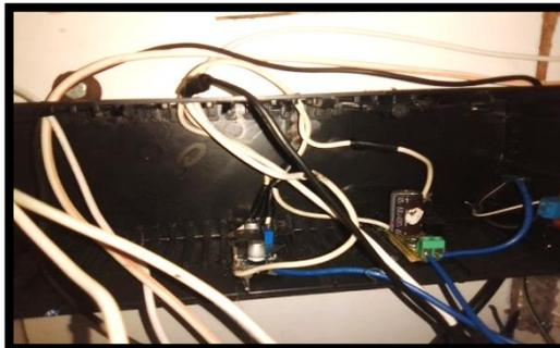
*Nota.* El puente rectificador está ubicado en la parte derecha, se lo puede identificar por el capacitor que está conectado a la salida hacia el inversor de la parte izquierda.
