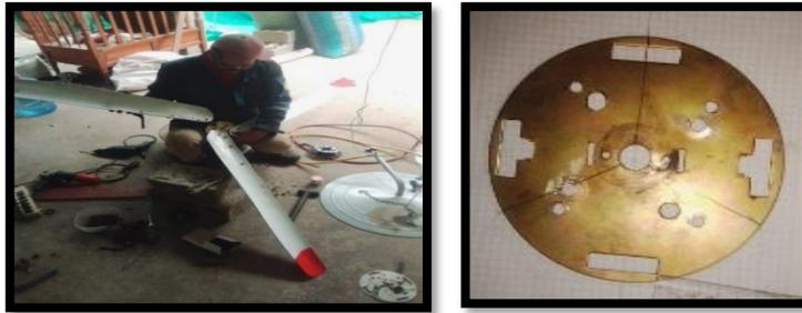
*Nota.* Para sujetar las aspas a la placa es necesario hacerlo con 3 pernos y tuerca, esto para mayor seguridad.
