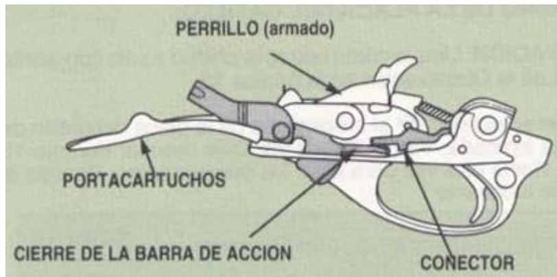
**Figura 6. 23 Rearmado de la escopeta**
