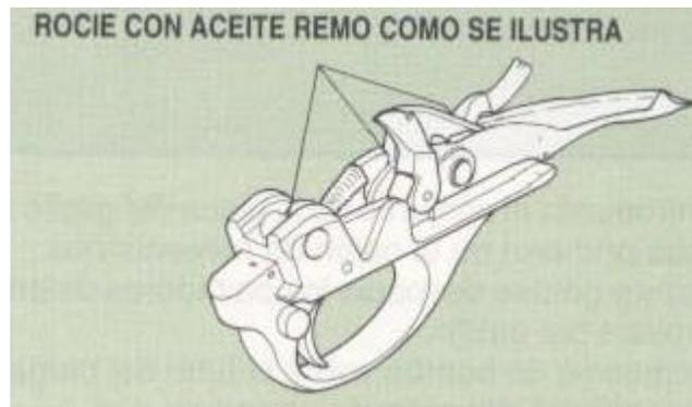
**Figura 6. 22 Limpieza de los mecanismos**
