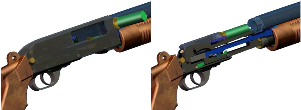
**Figura 3. 27 Salida del cartucho disparado y entrada del nuevo cartucho**
