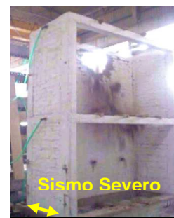
Fig.35. Confinamientos y refuerzo horizontal en el primer piso del módulo de adobe ensayado en mesa vibradora. Una de las conclusiones fue la necesidad de reforzar horizontalmente también al piso 2, para integrar todos los adobes con las columnas.
