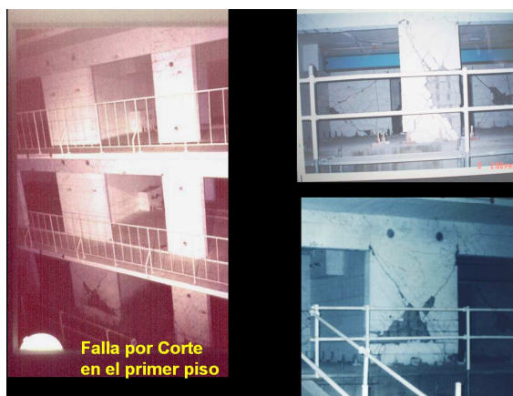
Fig.14. Experimento sísmico japonés en un edificio de 5 pisos de albañilería armada a escala natural [11].
