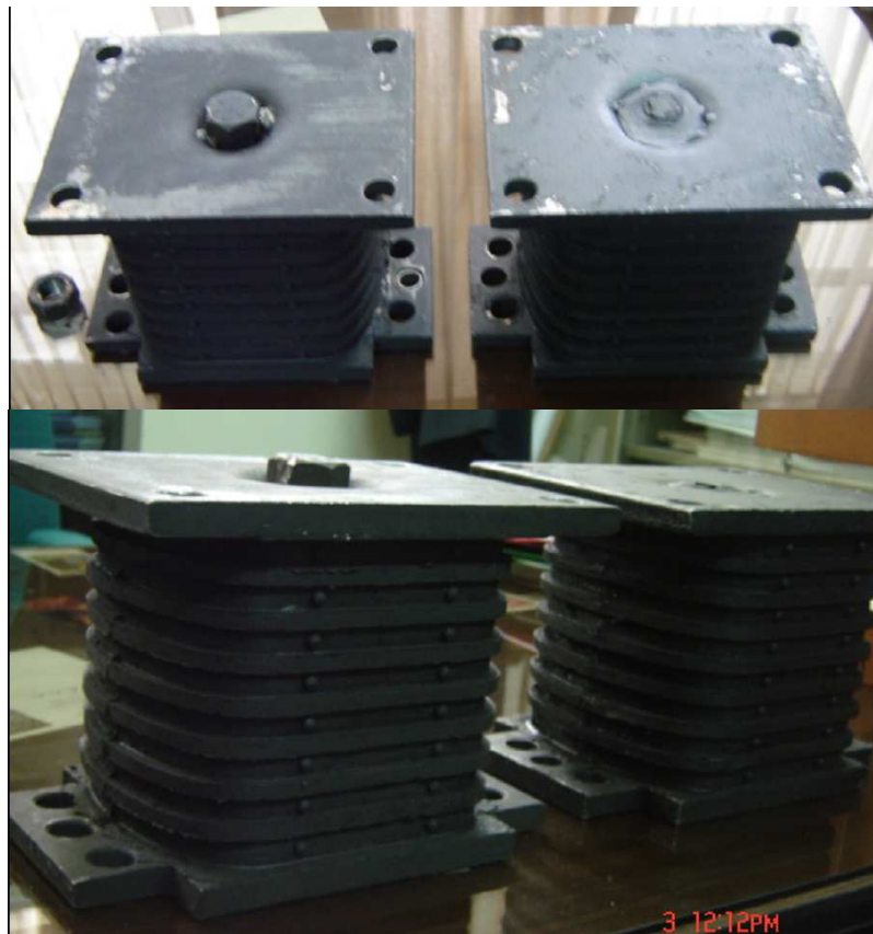
Figura 5 Prototipos de aisladores de base ensayados.
