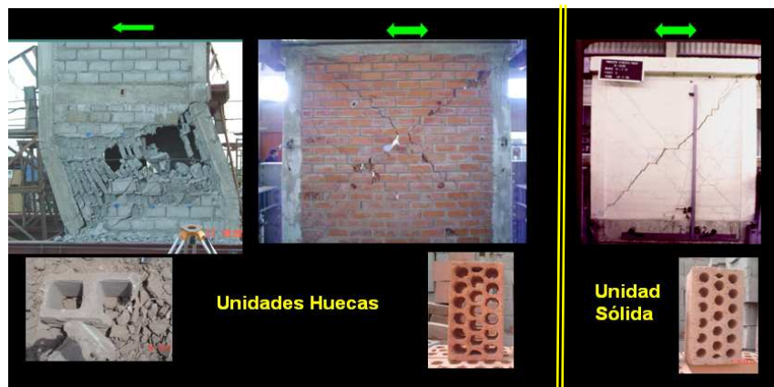
Fig.3 Trituración de unidades huecas con pérdida de área del muro, a diferencia de las unidades sólidas.
