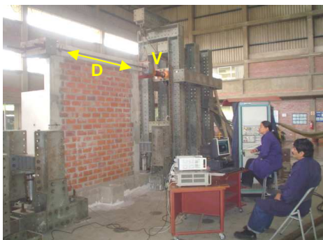
Fig.5. Ensayo de carga lateral cíclica y gráfica cortante-desplazamiento típica.
