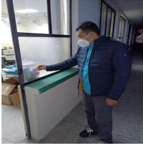
*Nota.* El docente verifico la funcionalidad del dispositivo de control de acceso al laboratorio de comunicaciones con el accesorio destinado para el acceso como es la tarjeta de proximidad RFID.
