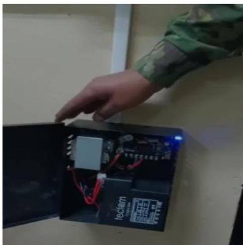
*Nota:* Instalacion fija contra la pared de caja metalica que contiene un circuito regulador de voltaje y bateria recargable de 12v.
