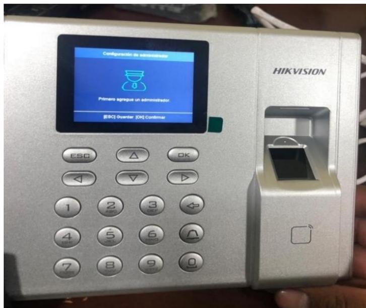
*Nota.* Permite realizar un control de gestión de acceso y asistencia, agrega huellas digitales, tarjetas de aproximación RFID y clave por consola al sistema de forma remota.
