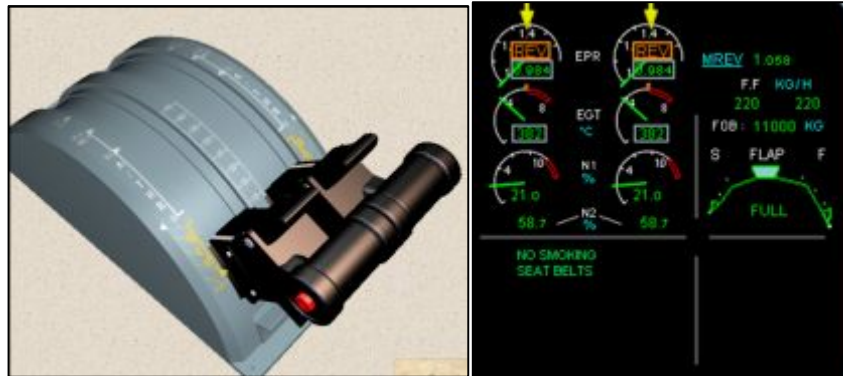
Figura 22. Indicación de la posición de la reversa
