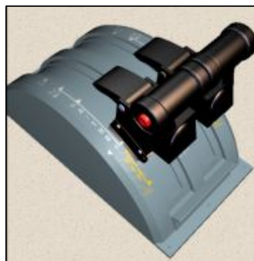
Figura 21. Activación de las palancas de reversa
