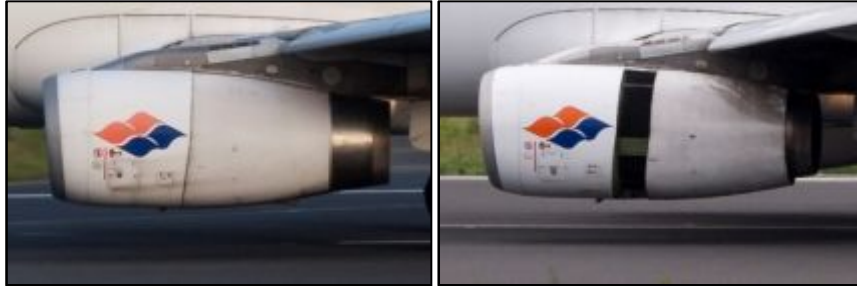
Figura 1. Reversa del fan de un avión A320
