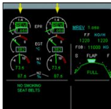
Figura 23. Indicación de la posición desplegada de la reversa
