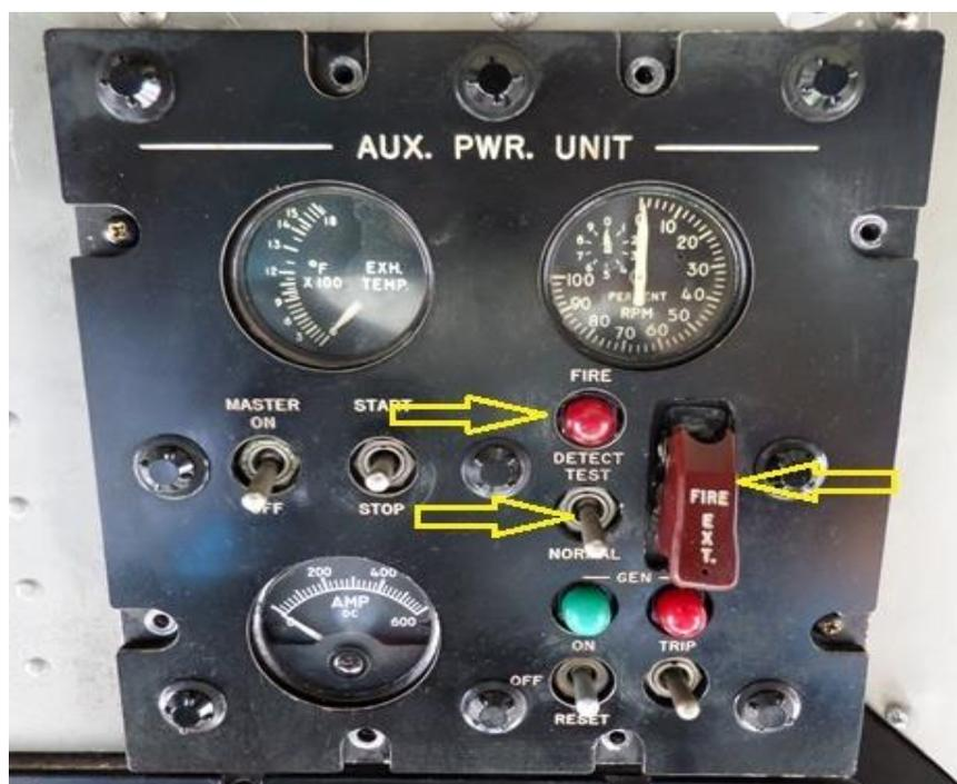
Figura 59. Luz de emergencia, switch del TEST y EXT.
