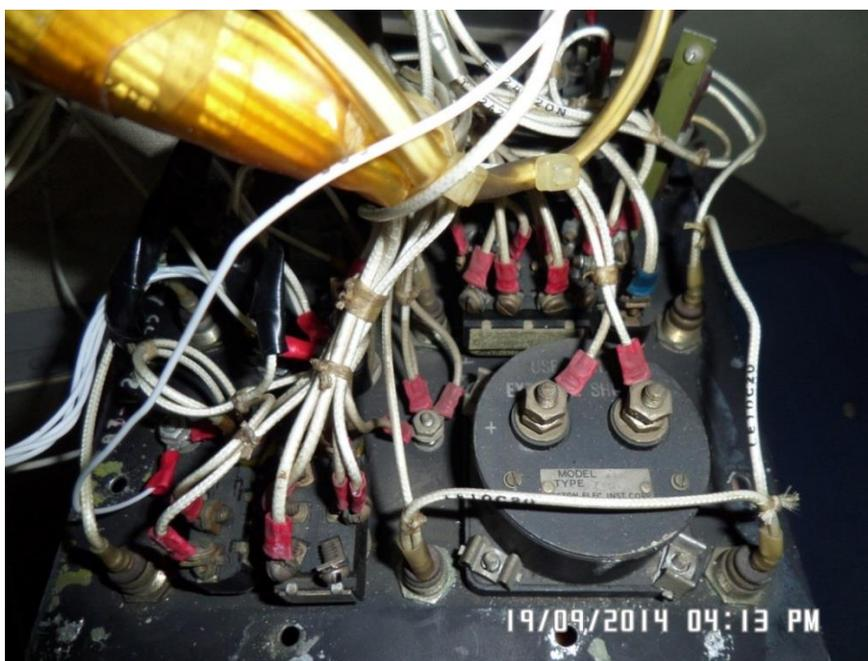
Figura 35. Limpieza de conexiones del panel del APU
