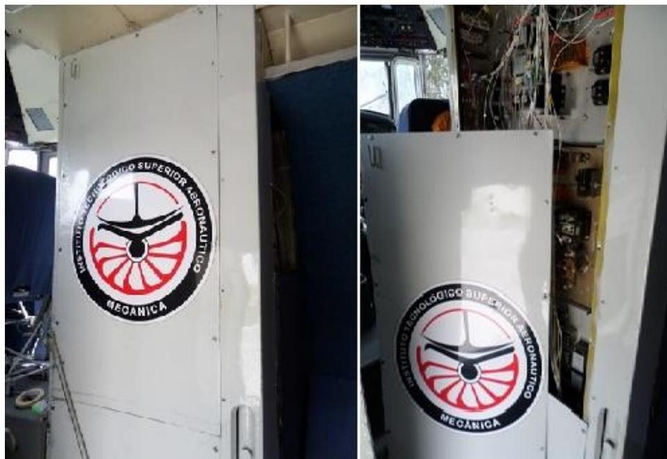
Figura 29. Panel de acceso a la barra bus de emergencia
