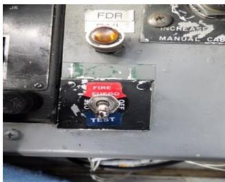
3. En el panel de la APU accione el switch de test y sin soltarlo se verifica el funcionamiento.
