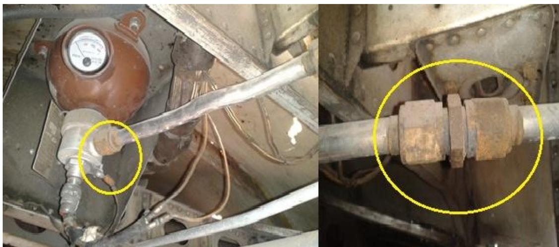
Figura 43. Conexión de cañerías en mal estado
