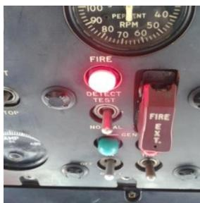
6. Luego de simular el corte o extinción de fuego se coloca el switch de tres posiciones en OFF.
