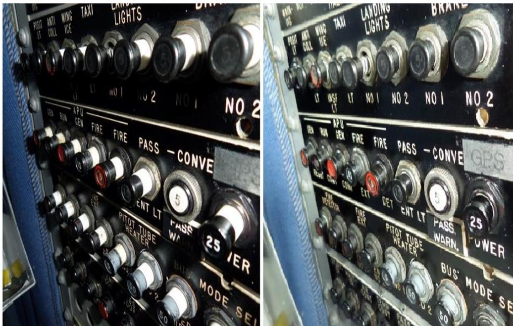
Figura 57. Panel de circuit break abierto y cerrado
