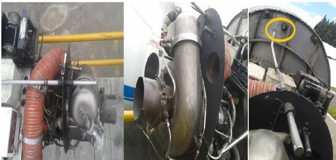
Figura 39. APU del avión Fairchild en malas condiciones
