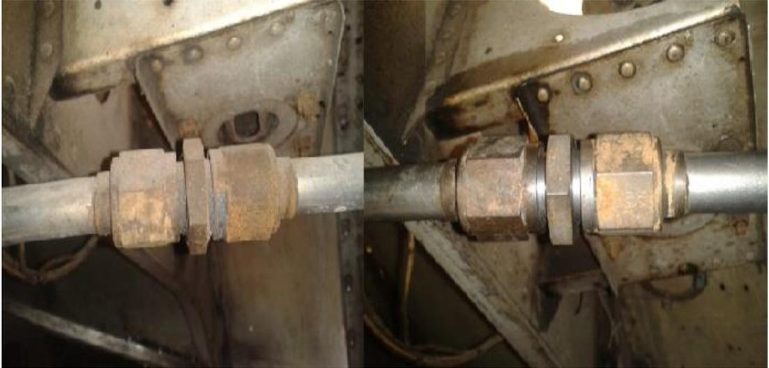
Figura 45. Limpieza de conexión de cañerías
