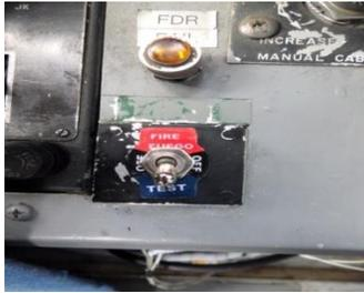
**NOTA:** Posterior a la operación del sistema de protección de fuego del APU del avión Fairchild revisar que los circuit break se encuentren abiertos y los switch tanto del panel del APU como el switch de tres posiciones se encuentren en OFF.
