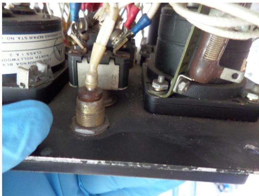
Figura 34. Limpieza del panel del APU
