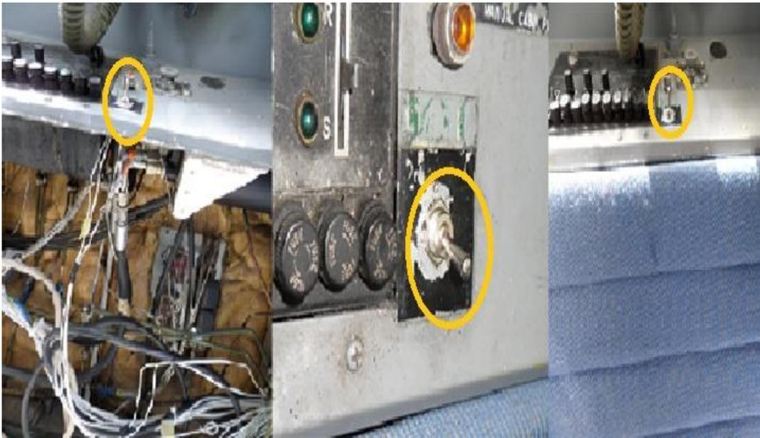
Figura 50. Instalación del switch de tres posiciones
