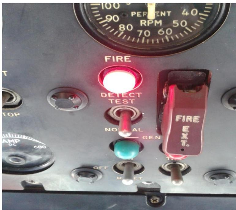
Figura 61. Test del sistema de protección de fuego del APU
