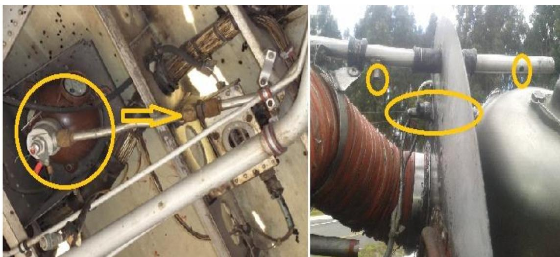
Figura 42. Cilindro y cañerías de extinción
