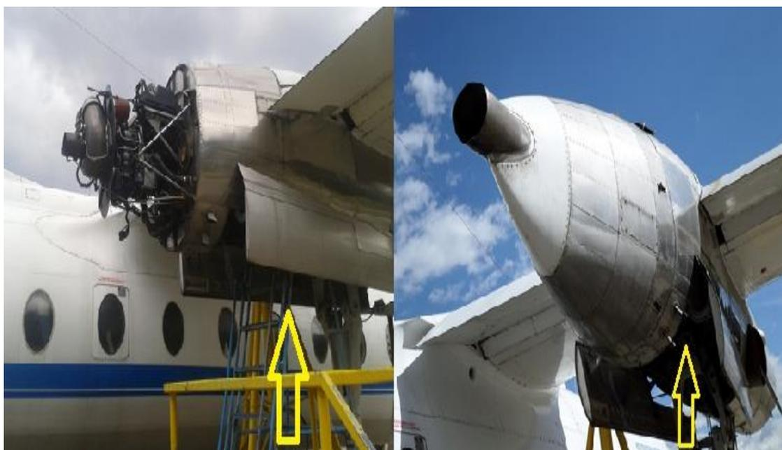
Figura 40. Acceso al cilindro con agente extintor
