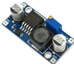
*Nota.* Adaptado de la datasheet la descripción *del convertidor de voltaje DC-DC LM2596*, [gráfico], 2022, CC BY 2.0
