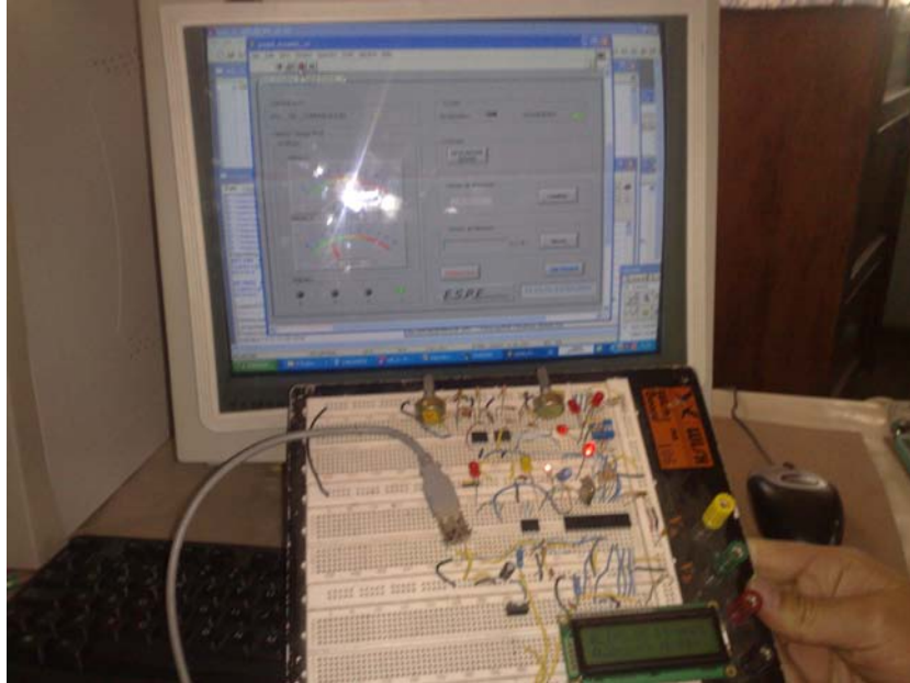
Fig. 3.5: Comprobación del funcionamiento autónomo del módulo data logger y conexión en caliente.
