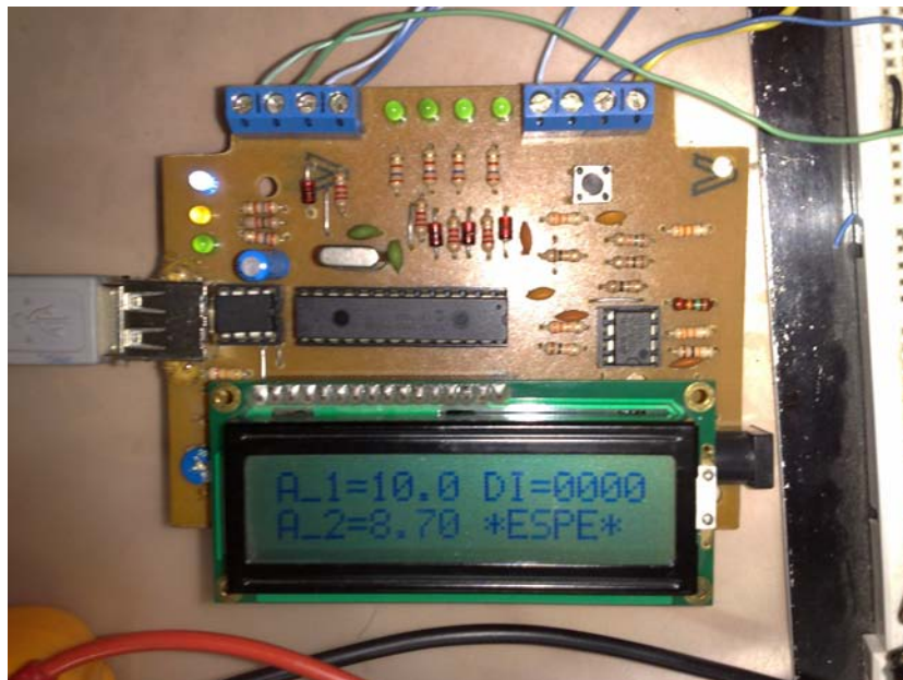
Fig. 3.6: Circuito del data logger realizado en placa.
