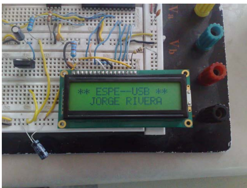
Fig. 3.4: Comprobación del funcionamiento del módulo data logger después de migrar el software del microcontrolador.
