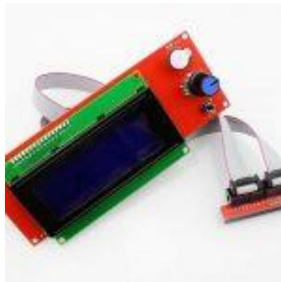
*Nota.* Este display ya tiene incluido ranura para tarjeta SD y perilla selector de funciones para maquina CNC. Tomado de (TECmikro, 2022).
