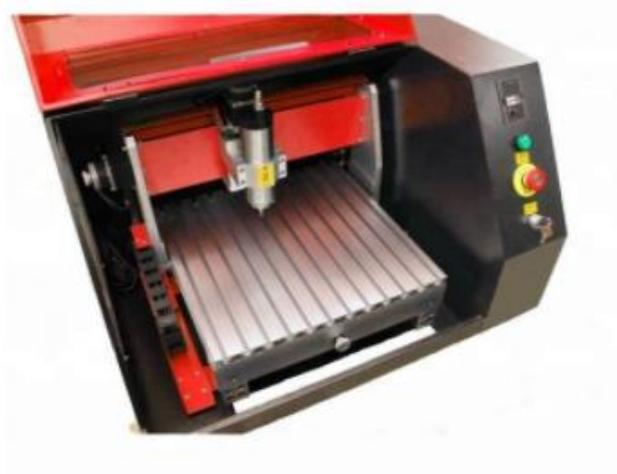
*Nota.* Prototipo de una máquina fresadora CNC multifunción. Tomado de (TecnoEdu, 2019).
