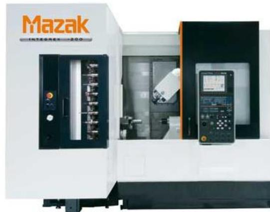
*Nota.* Integrex J200 se representa como una máquina pesada, entre otros, esta se emplea para usuarios de tornos y centros de mecanizado CNC. Tomado de (METALMECANICA, 2011).
