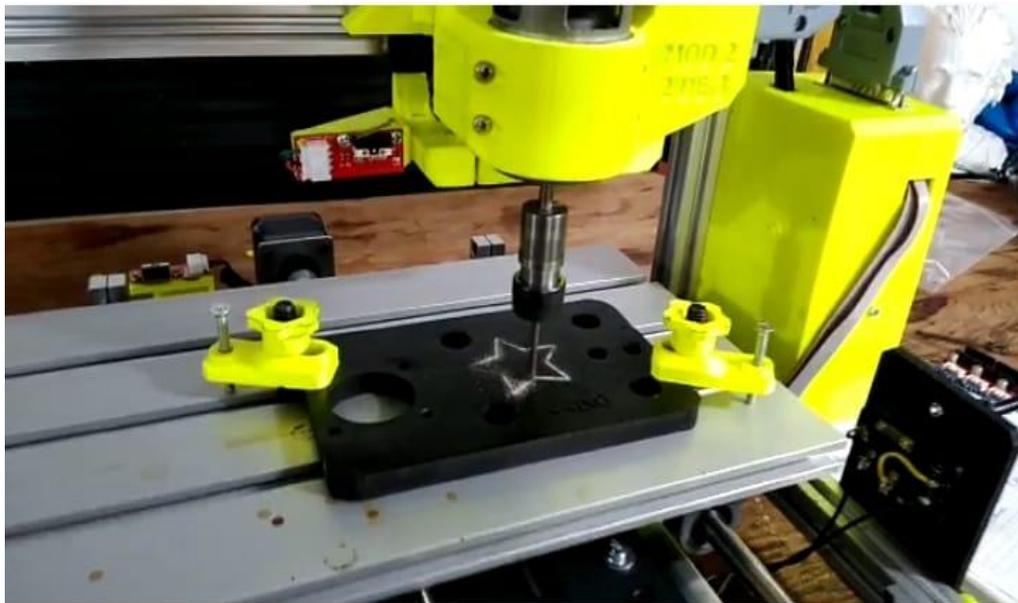
*Nota.* Cabezal router en funcionamiento.
