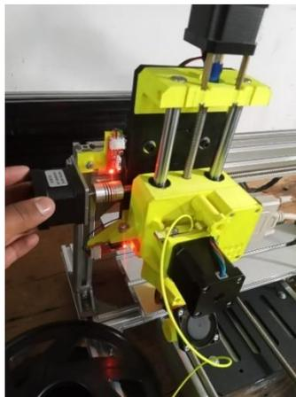
*Nota.* Establecimiento de los motores y la cama en caliente con una limitación mediante los finales de carrera.
