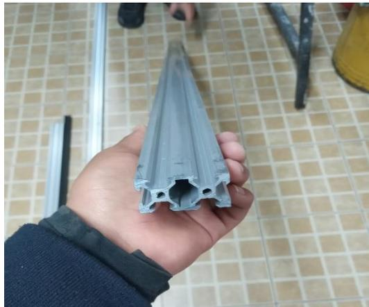
*Nota.* Este perfil establece un movimiento adecuado para el traslado de las ruedas del carrusel que conforma dentro del cabezal.
