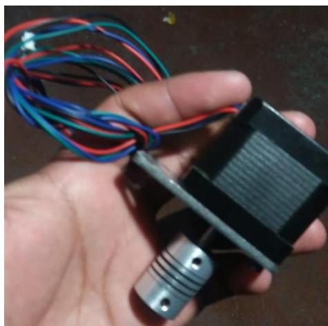
*Nota.* Motor paso a paso con acople flexible.
