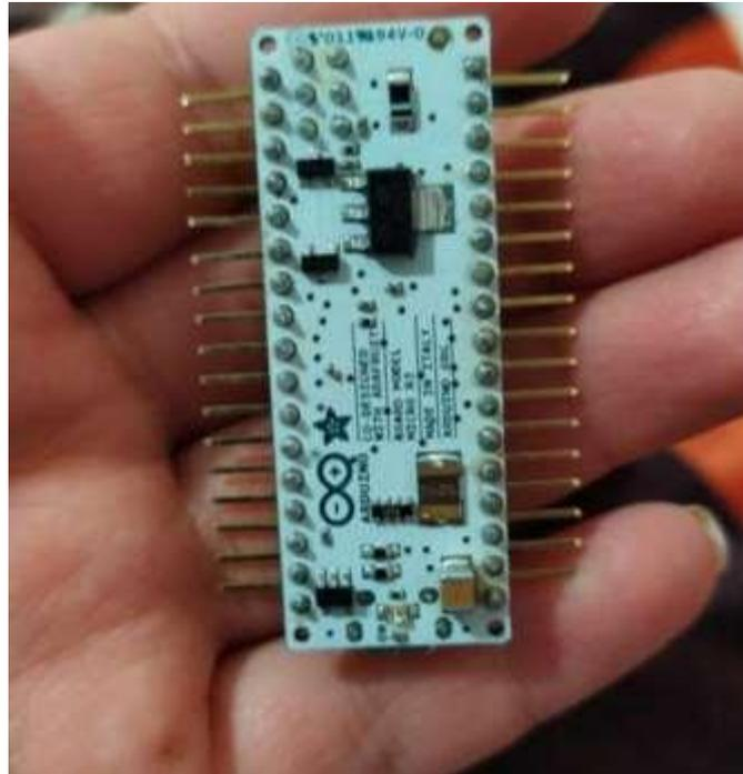
*Nota.* En la siguiente figura se aprecia cómo se está realizando el proceso de soldadura o acople entre la placa de Arduino y los espadines
