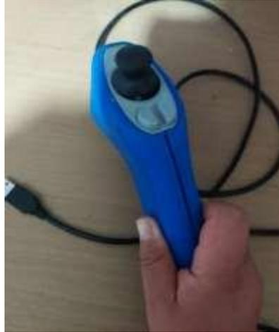
*Nota.* En la siguiente figura observamos el prototipo del dispositivo periférico de entrada ya culminado, donde el joystick hará la función del curso del ordenador y las botoneras serán la simulación de click tanto izquierdo como derecho.
