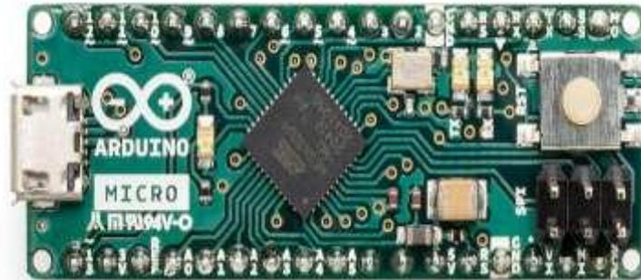
*Nota.* En la figura se puede apreciar una placa de Arduino que 20 pines de entrada/salida digital (de los cuales 7 se pueden usar como salidas PWM y 12 como entradas analógicas), un oscilador de cristal de 16 MHz, una conexión micro USB, un encabezado ICSP y un botón de reinicio. Tomado de Arduino.cl, 2019.
