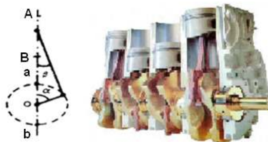
Fig. 1.1. Movimiento biela – manivela
