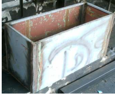
Fig. 4.6 Tanque armado y soldado
