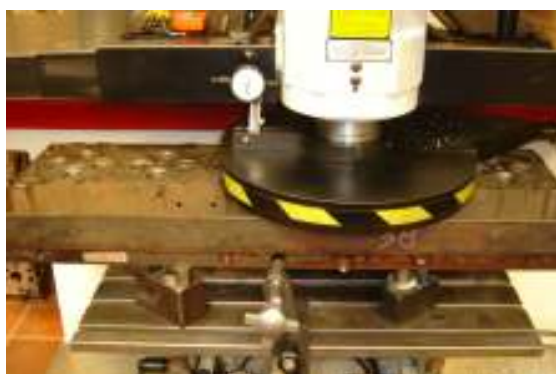
Fig. 2.5 Rectificación de planitud de culata
