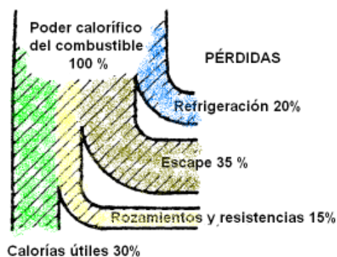
Fig. 1.1 Porcentajes de pérdidas de calor en el motor
