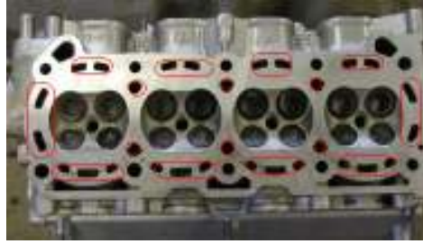
Fig. 5.7 Conductos de refrigeración
