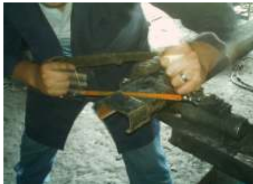
Fig. 4.7 Corte de las bases del tanque
