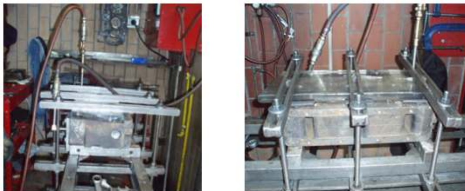
Fig. 2.6 Prueba de estanqueidad vista frontal y lateral
