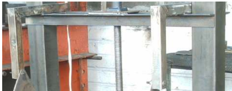
Fig. 4.13 Brazos y rieles ensamblados
