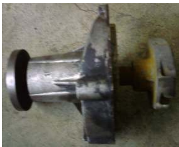
Fig. 1.4 Bomba de agua
