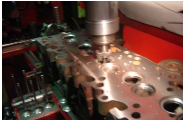
Fig. 2.3 Fabricación y rectificación de la culata
