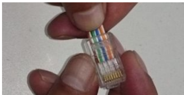
Figura 52. Insertar los Hilos Conductores
