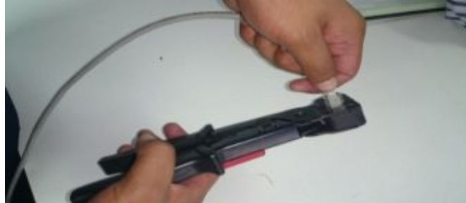
Figura 53. Procedimiento para Ponchar
