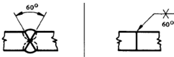
Figura 6.15: Detalle de la Junta Soldada.
