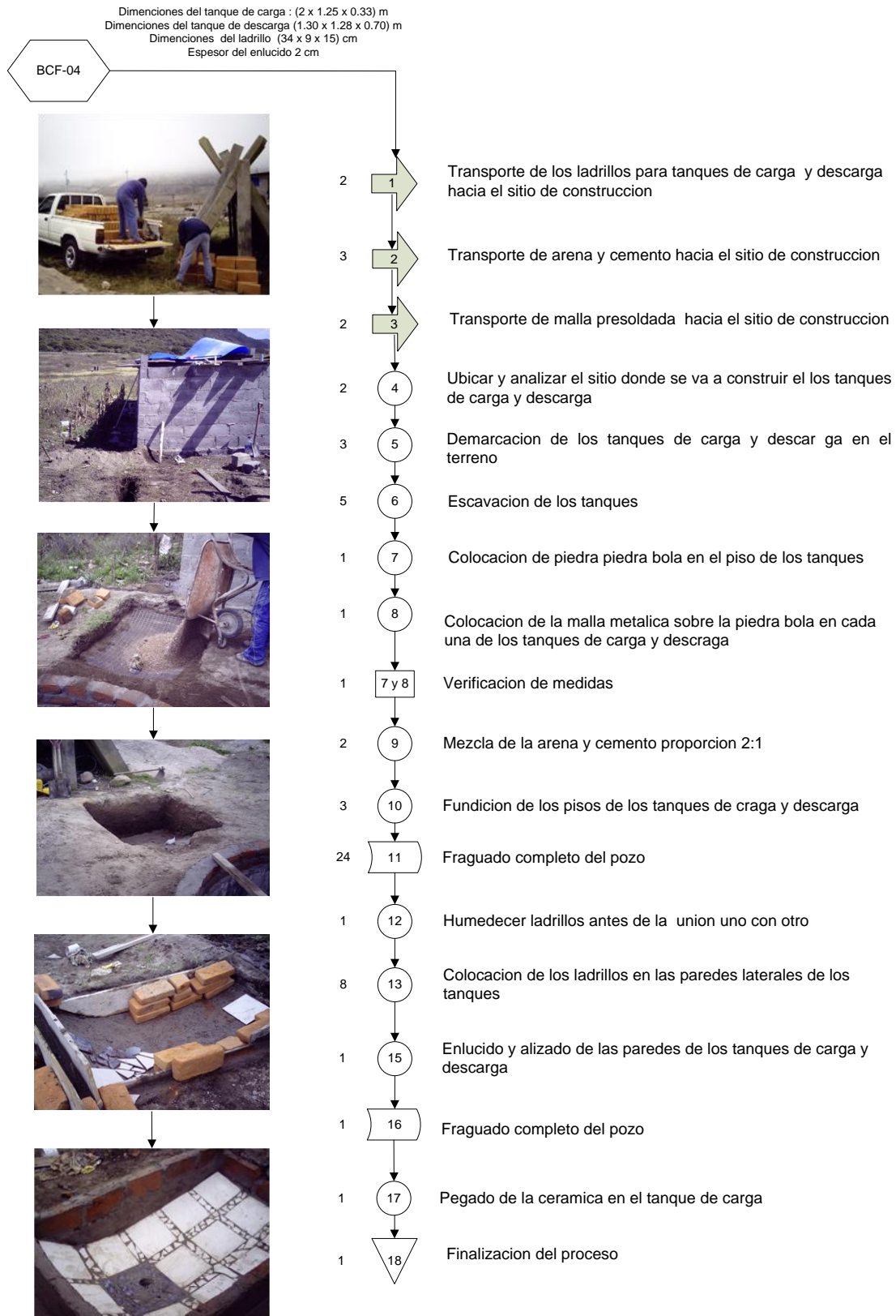
Diagrama 6.4: Proceso para la construccion de los tanques de carga y descarga
