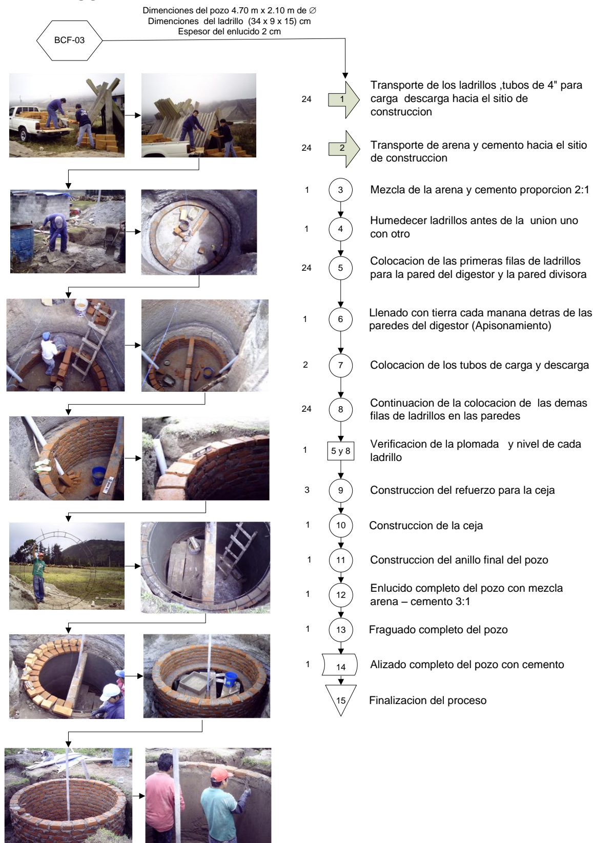
Diagrama 6.3: Proceso para la construccion de la pared externa y divisora
