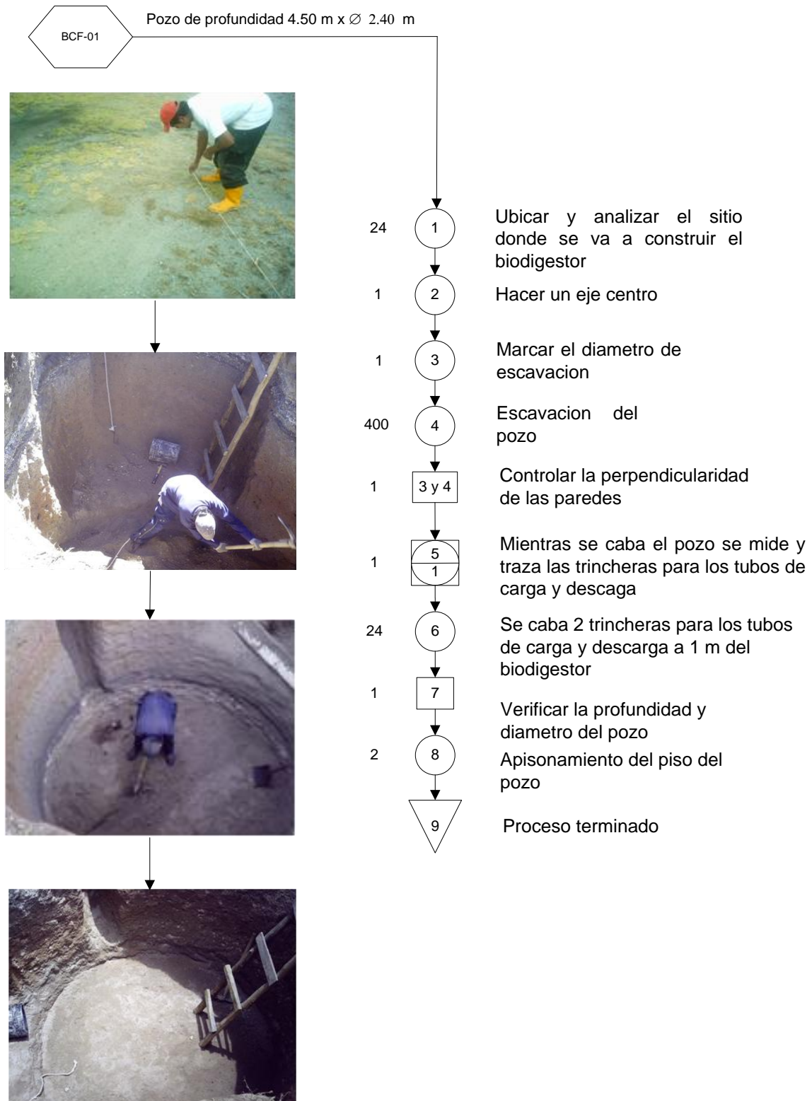
Diagrama 6.1: Proceso para la escavacion del pozo
