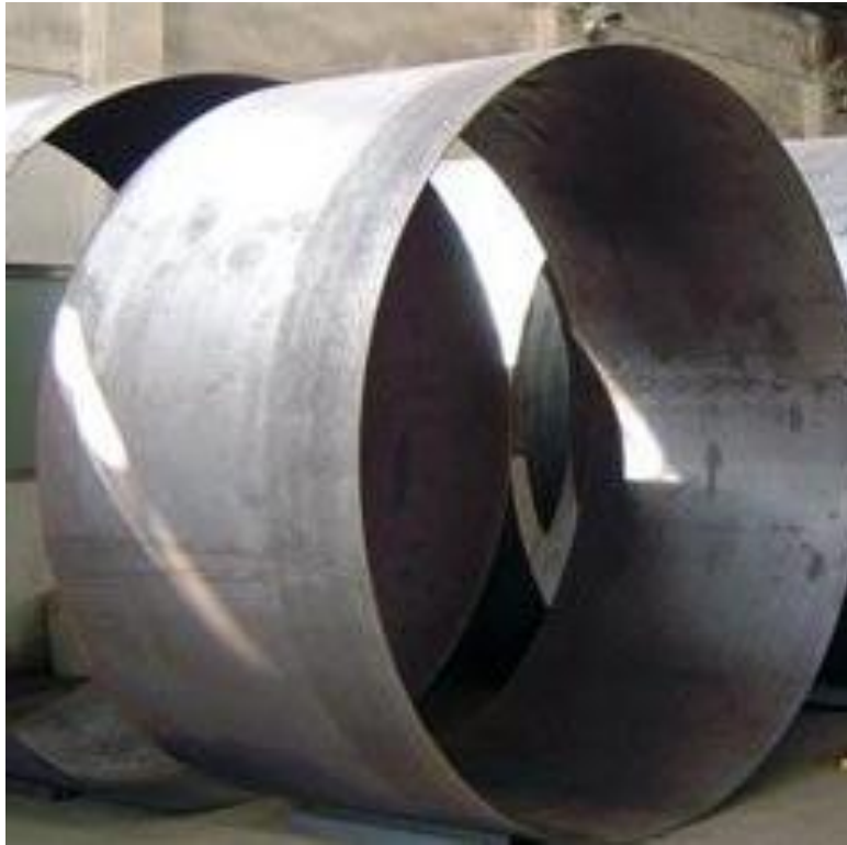
Fotografía 6.33: Anillo Principal del Gasómetro Soldado.
