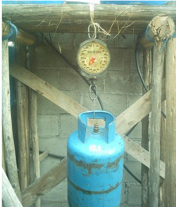
Fotografía 9.8 Peso del tanque de GLP
