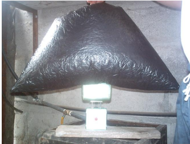
Fotografía 9.7 Peso del Recipiente Lleno de Biogás
