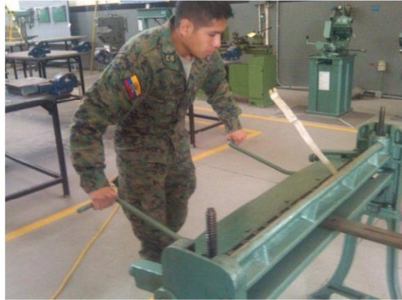
**Figura 2. 11** Dobles de una Lámina
