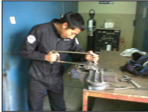
Figura 3.14: Corte de los tubos Fuente: José Hernández
