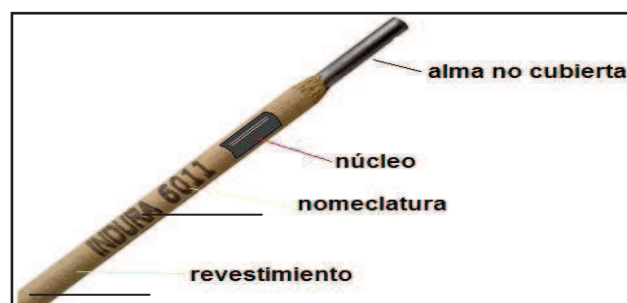
Figura 2.26: Partes constitutivas de un electrodo para suelda por arco Fuente: www.mpw.cl/como-elegir-electrodos.htm
