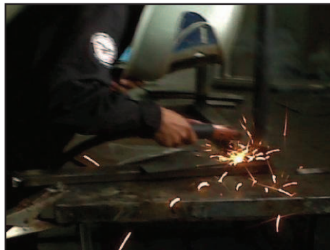
Figura 3.15: Punteada de la estructura fija Fuente: José Hernández
