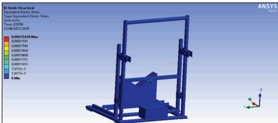
Figura 3.8: Deformación unitaria de la maquina Fuente: José Hernández
