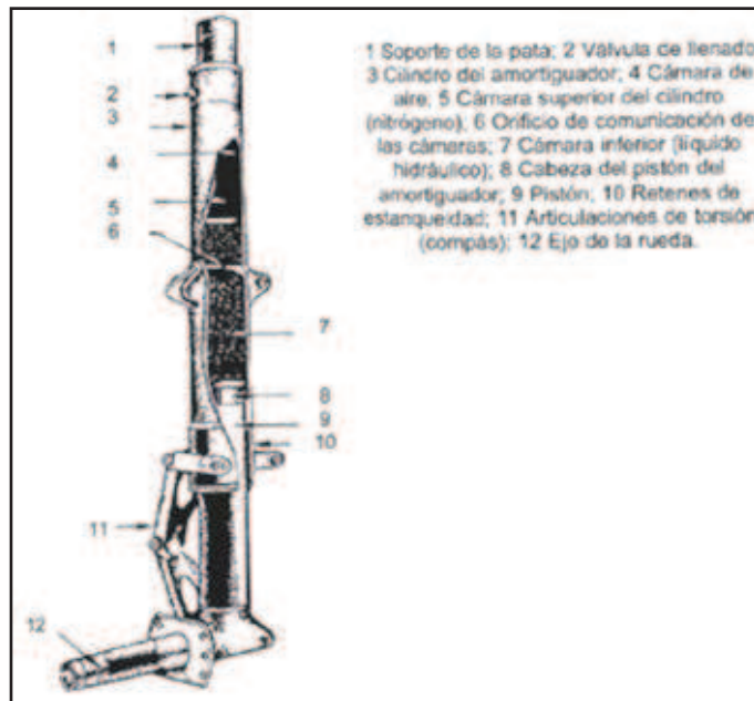
Figura 2.7: Amortiguador oleoneumático
