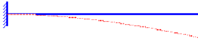
Figura 1.27 Barras empotradas en un extremo y libres en el otro k = 2.00
