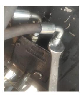
Nota. La fotografía muestra el acoplamiento de las líneas hidráulicas con sus respectivos acoples a la válvula reguladora manual.
