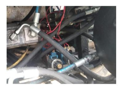
Nota. La fotografía muestra la conexión completa de líneas hidráulicas de los elementos hidráulicos válvulas depósito, y la bomba hidráulica.
