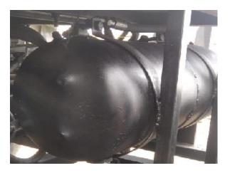
*Nota.* En la fotografía podemos observar el montaje del depósito hidráulico en el banco de entrenamiento de maquinaria pesada.
