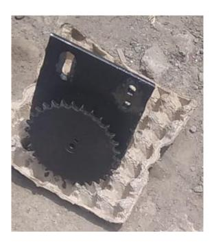
Nota. La fotografía muestra el montaje de un piñón al eje de salida del motor hidráulico
