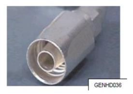
Nota. El gráfico representa un acoplamiento tipo tornillo que se los utiliza para conectar mangueras de fluidos hidráulicos. Tomado de: (Técnico, 2001)
