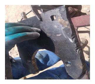
Nota. La fotografía demuestra la construcción de las bases donde se montaran los motores giro hidráulicos los cuales se centraran en el banco de entrenamiento.
