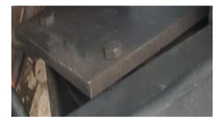
Nota. La fotografía muestra la base rectangular con donde se va asentar la bomba hidráulica evitando que tenga rozamiento con el volante de inercia.
