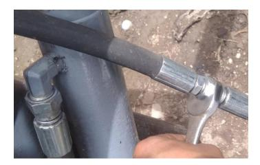
Nota. La gráfica muestra la conexión de las mangueras con su respectivo acoplamiento al cilindro doble efecto.
