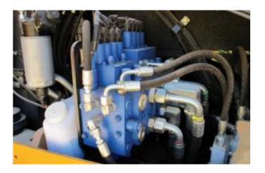
Nota. El gráfico representa la conexión de mangueras de alta presión al cuerpo de válvulas hidráulicas. Tomado de:(CHUCHUCA & JADAN, 2020)
