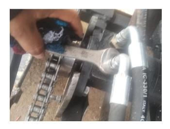
Nota. La fotografía muestra la conexión de mangueras hidráulicas a los motores hidráulicos que viene desde las válvulas direccionales.
