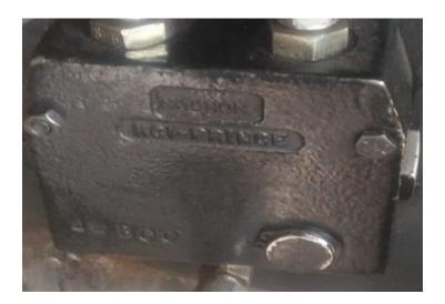
Nota. La fotografía muestra la válvula reguladora de presión que ayuda manualmente a reducir el flujo de aceite del sistema hidráulico del banco de entrenamiento de maquinaria pesada.
