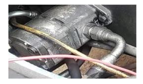
Nota. La fotografía muestra las respectivas conexiones de una bomba hidráulica para posteriormente realizar la prueba de funcionamiento en el banco de entrenamiento de maquinaria pesada
