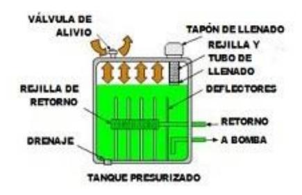
Nota. El gráfico presenta el depósito o tanque hidráulico donde se almacena el fluido para sistemas hidráulico. Tomado de:(Gaona, 2014)
