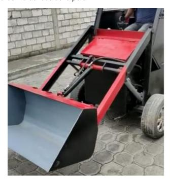
Nota. La fotografía muestra la prueba de funcionamiento de los cilindros de la pala del banco de entrenamiento de maquinaria pesada.
