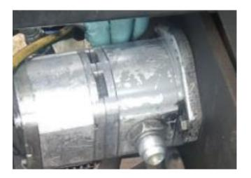
Nota. La fotografía muestra el montaje de la bomba hidráulica la cual se conecta por medio de su eje a un acople esencial que está adaptado al volante de inercia para su funcionamiento.
