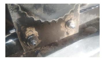
Nota. La fotografía muestra en montaje del motor hidráulico al bastidor del banco de entrenamiento de maquinaria pesada.
