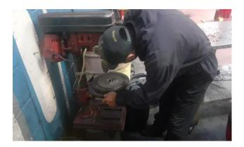
Nota. La fotografía muestra la perforación del volante de inercia para una buena adaptación con la bomba hidráulica.
