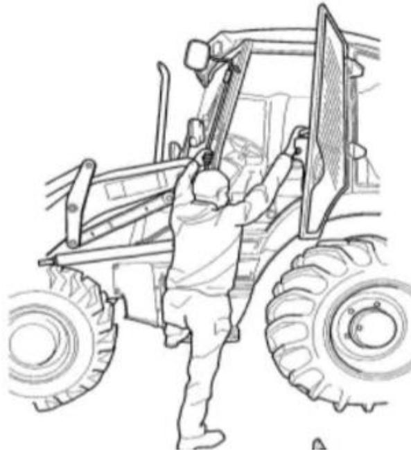
*Nota.* Forma correcta para ingresar o salir de la retroexcavadora. Tomado de (JCB, 2020)
