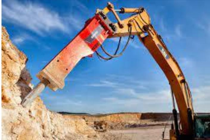
*Nota.* Martillo hidráulico, es de gran importancia para poder atravesar concreto y asfalto.
