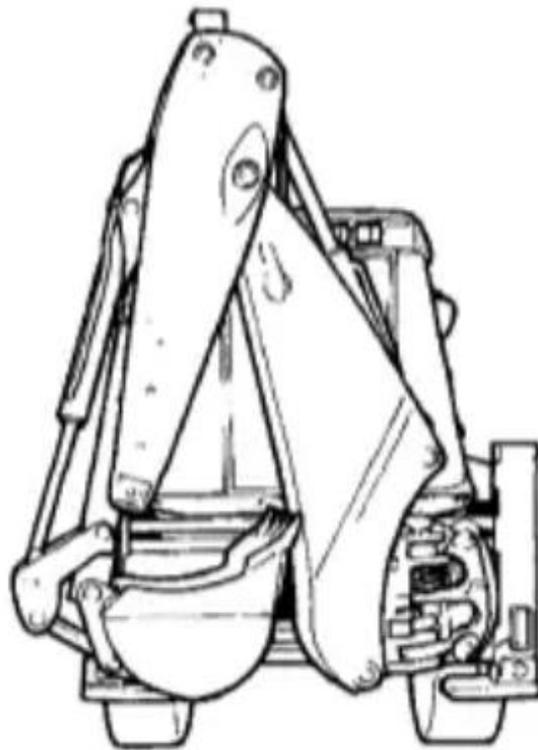
*Nota.* Como se debe contraer las herramientas para así evitar daños en el vidrio posterior de la retroexcavadora. Tomado de (JCB, 2020)
