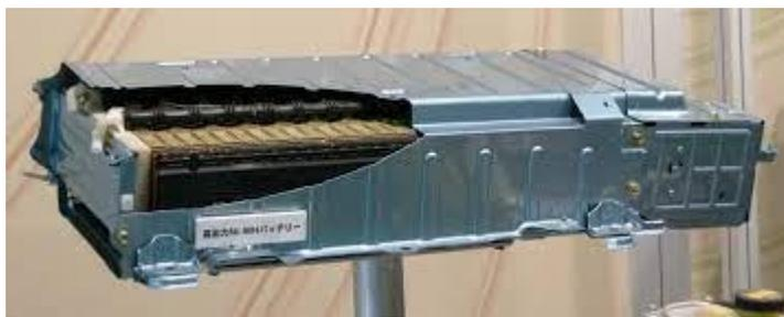
*Nota.* La figura nos indica una batería de níquel-hidruro metálico y la disposición de las celdas internamente (El periodico de la energia, 2015).
