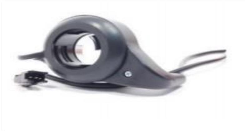
*Nota.* La siguiente figura muestra el acelerador que se adquirió para la implementación del sistema de propulsión. Tomado de (motorparabicicleta, S/F).
