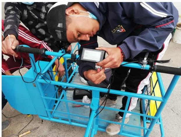
*Nota.* La siguiente figura muestra la sujeción del panel al manubrio del triciclo una vez que fue colocado en el centro del manubrio del triciclo.
