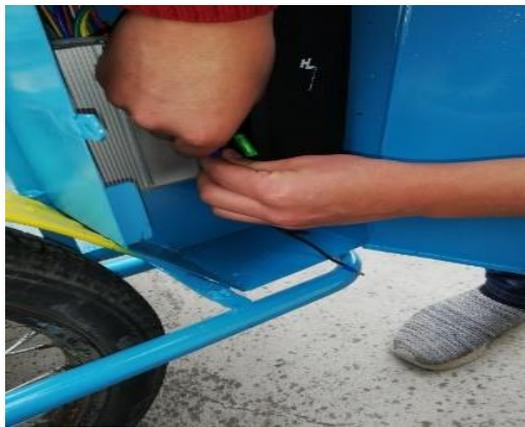
*Nota.* La siguiente figura muestra la respectiva conexión de los cables de la base de la batería con los cables de alimentación del controlador.
