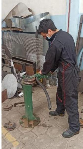
*Nota.* En la imagen se observa el doblado de tubos realizado durante la construcción del chasis.
