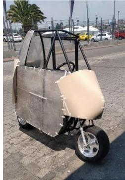
*Nota.* En la imagen se puede ver los laterales hechos en fibra del vehículo y los moldes hechos con cartón para realizar las piezas delantera y trasera en fibra de vidrio.
