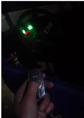
*Nota.* En la imagen se muestra el funcionamiento del encendido remoto del vehículo con el mando a distancia comprobando su funcionamiento
