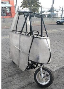
*Nota.* En la figura se observa la carrocería del monoplaza hecha con fibra de vidrio terminada.
