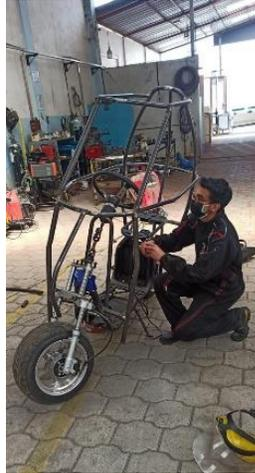
*Nota.* En la imagen se observa la revisión visual que se realizó en los tubos después de cada unión con soldadura
