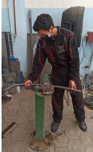
*Nota.* En la figura se observa el proceso de doblado de tubos para dar la forma ovalada al vehículo.
