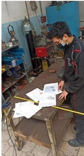
*Nota.* En la figura se observa la lectura de los bocetos y su utilización como guía para el corte y doblado de los tubos.
