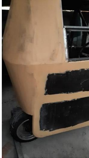
*Nota.* En la ilustración se puede ver la carrocería de fibra de vidrio con acabados realizados con masilla con el fin de rellenar las imperfecciones de la fibra.
