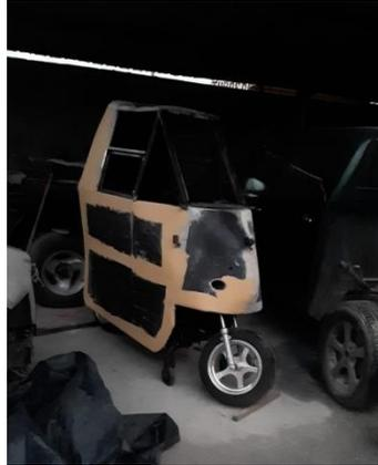
*Nota.* En la ilustración se puede ver una vista frontal de la carrocería de fibra de vidrio con acabados realizados con masilla con el fin de rellenar las imperfecciones de la fibra.
