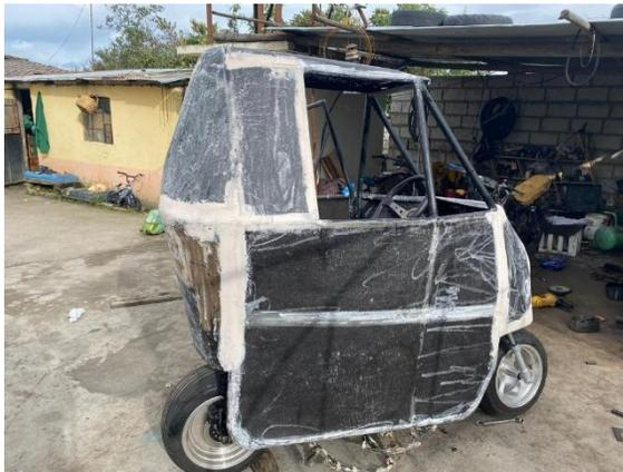
*Nota.* En la ilustración se puede ver la carrocería de fibra de vidrio con acabados hechos con masilla para moldear la estructura.
