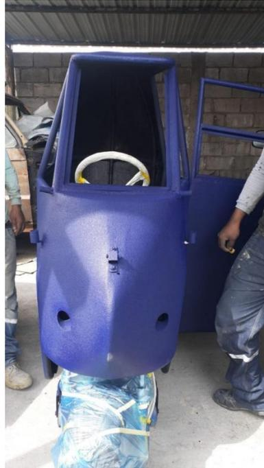
*Nota.* En la figura se observa una vista frontal de la carrocería del monoplaza con su proceso de pintura terminado
