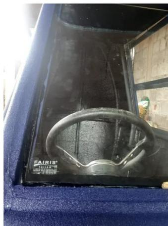
*Nota.* En la figura se observa el parabrisas del monoplaza colocado en su sitio.
