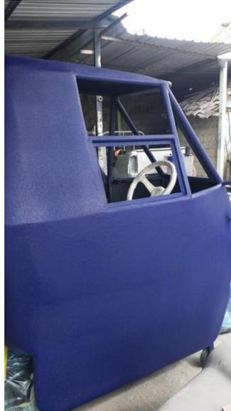
*Nota.* En la figura se observa una vista lateral de la carrocería del monoplaza con su proceso de pintura terminado.
