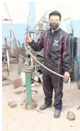
*Nota.* En el gráfico se observa el acabado final del proceso de modificación de la forma y tamaño de los tubos.
