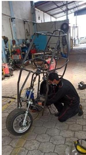
*Nota.* La figura muestra el proceso seguido para el montaje de las piezas para la construcción del chasis tubular del monoplaza eléctrico.
