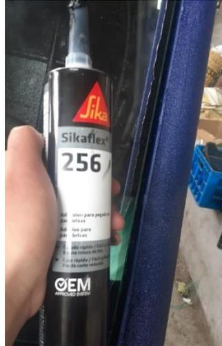
*Nota.* En la imagen se observa el silicón negro utilizado para la colocación del cristal del parabrisas delantero.
