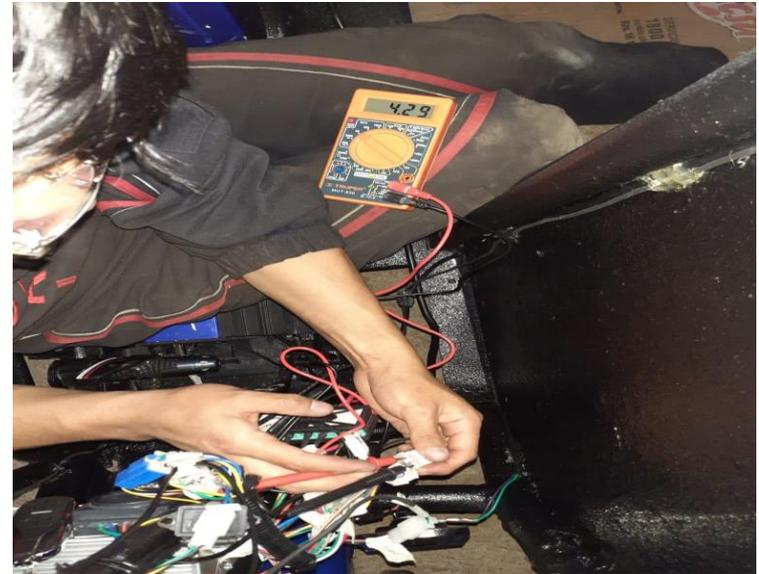
Medición de señal del controlador al motor.
