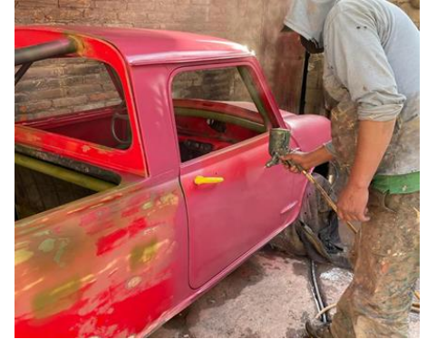
Aplicación de imprimación
