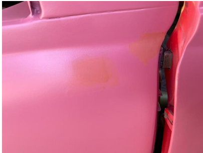
Aplicación de masilla poliéster
