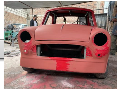
Aplicación de masilla poliéster
