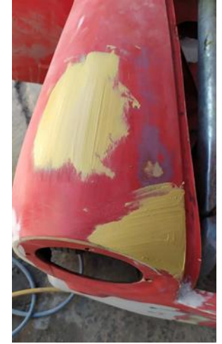
Aplicación de masilla
