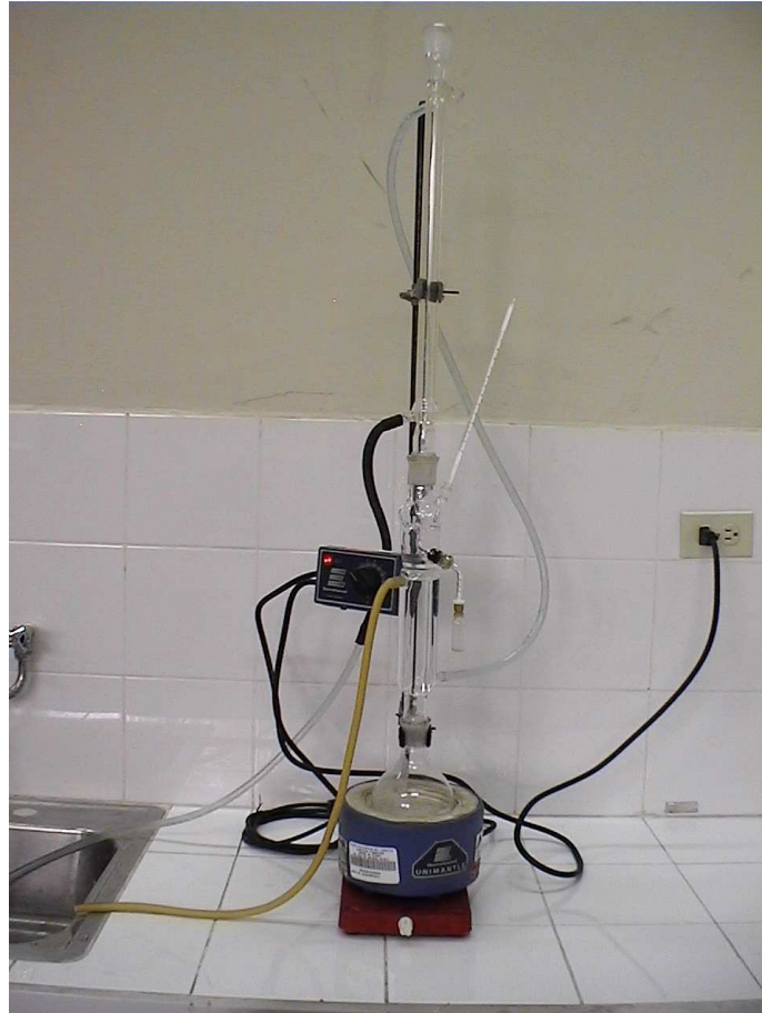
Figura 5 Columna de destilación fraccionada experimental.
