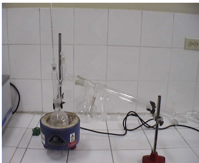
Figura 4 Destilación simple de gasolina
