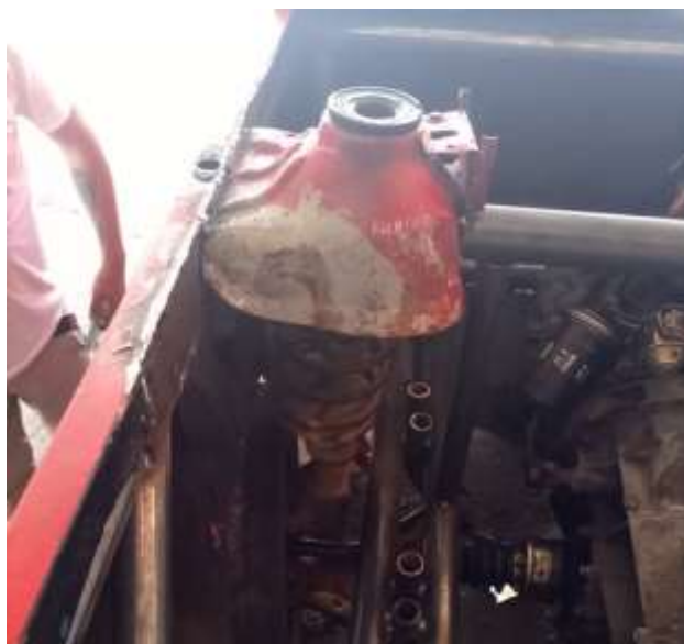
Figura 73. Soldadura de torretas de suspensión
