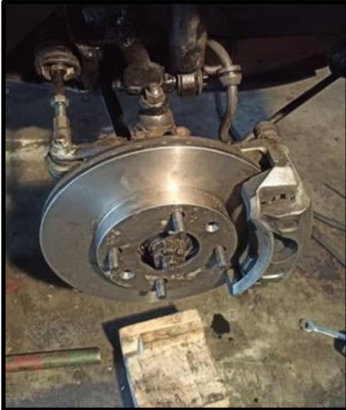
Montaje de componentes del sistema de freno
