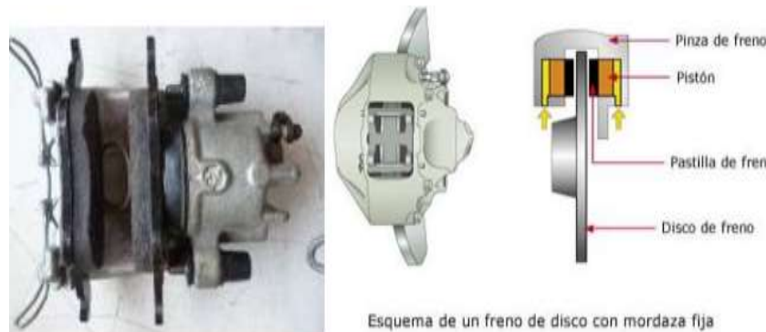
Figura 33 Esquema freno de disco con mordaza.
