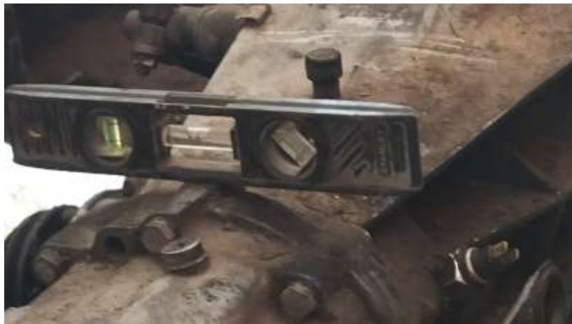
Figura 42 Puesta a nivel de motor y transmisión.
