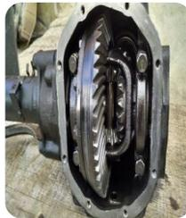
Los satélites: son engranajes de dientes cónicos rectos, junto con los planetarios forman parte del conjunto diferencial estos no poseen un estriado interior y giran locos en conjunto con los planetarios para conseguir que los ejes motrices giren a distintas velocidades.
