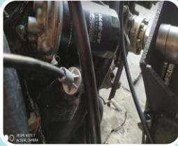
Debido a que la posición de la caja y del motor cambió, el embrague necesita conectarse al actuador, mediante la leva de embrague que deberá llegar al pedal
