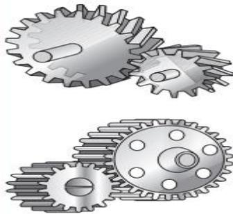
**Piñones:** acoplados en pares de transmisión, uno conductor (transmite las revoluciones del motor) y otro conducido.
