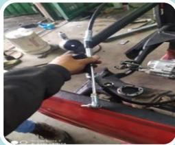
Después de instalar el cable y corroborar que el cableado servirá de forma que pueda fluctuar entre marchas adelante y atrás se procede a montar en el vehículo usando desde la torreta la parte que acciona
