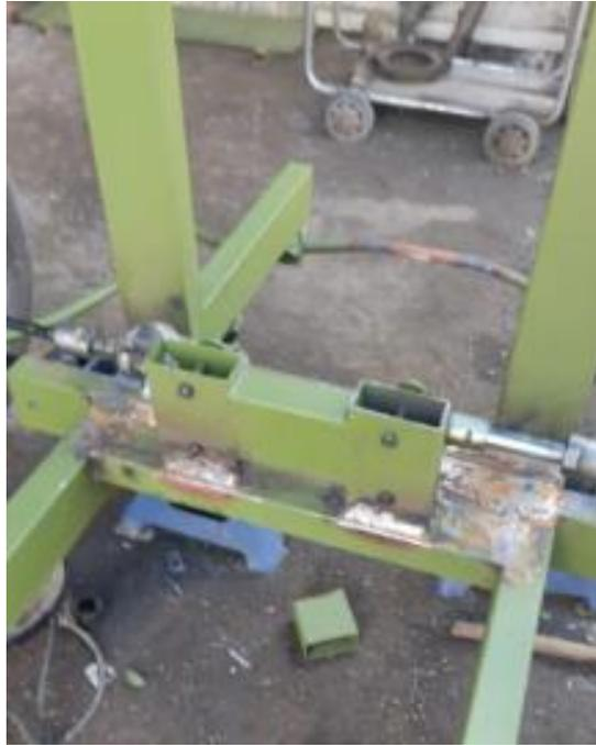
*Nota.* Elaboración de la consola para los resortes, volante y sistema de frenado.
