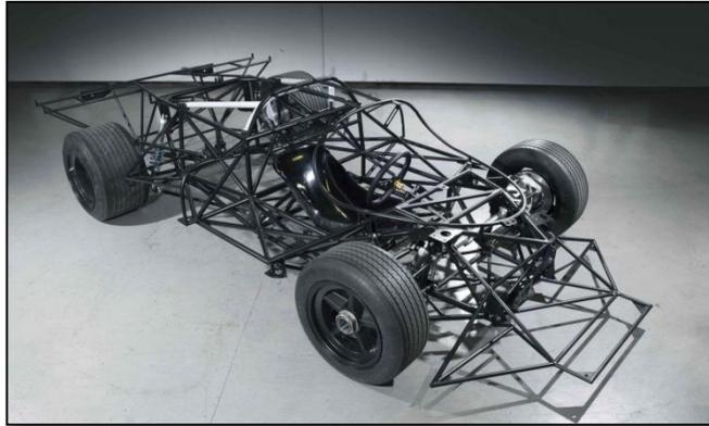
*Nota.* Se observa la forma de un chasis tipo tubular. Tomado de (Costa 2019).
