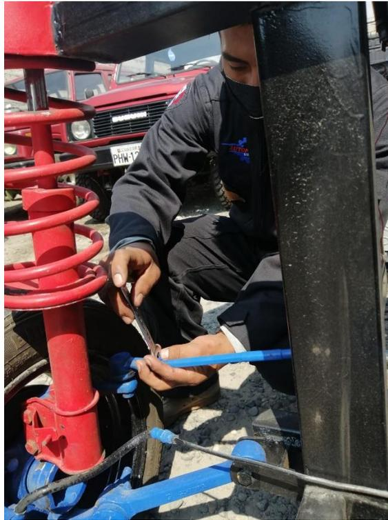
Instala la cremallera se procede a la conexión con los terminales y a la unión con la mangueta. En los extremos de la cremallera se une el tirante con los terminales y de ahí a la conexión con la mangueta el cual une tanto elemento de la dirección con la de la suspensión.
