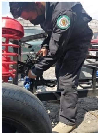
Con ayuda de la platina de dirección colocamos 6 pernos 10, 3 pernos de enumeración M8 x 20mm son colocados en la parte de arriba y en la parte inferior colocamos las 3 pernos y tuercas de la misma enumeración mencionada anterior mente para la sujetar la dirección y no pueda caer.
