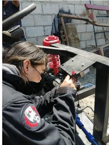
En la figura 65 se muestra la salida del cable de la batería que son dirigidas hacia las entradas B y C que va directamente desde la batería por las líneas de la carrocería que pasa por el motor y va directamente a la fusilera que regula el paso de corriente enviando la cantidad respectiva a la ECU.
