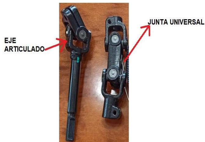
En la figura 46 se muestra la conexión del eje articulado y la junta universal que está incorporada hacia la dirección electro asistida. Ya lista la conexión se procede a la carrocería para instalarla con la cremallera y observar si tiene movilidad desde el volante hacia las ruedas delanteras.
