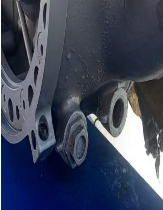
Instalación de lockwire en componentes
