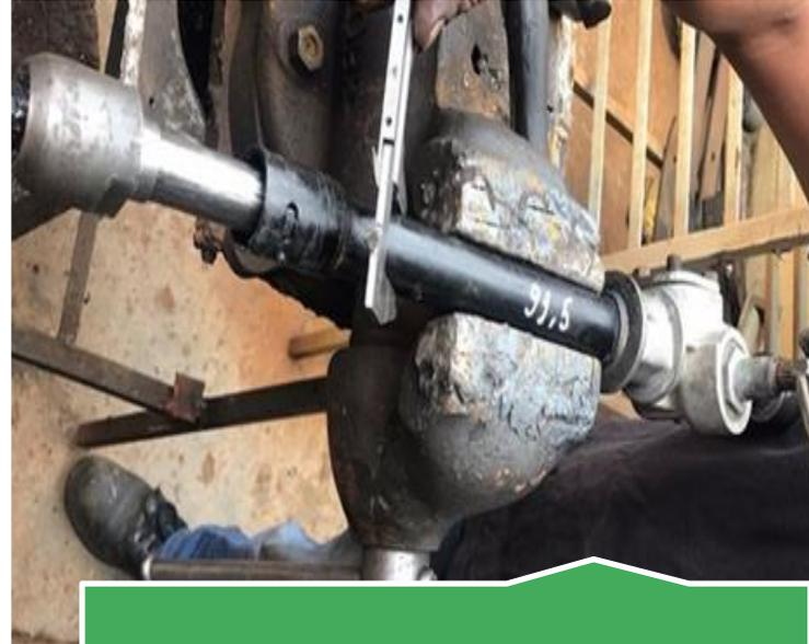
Recorte de brazos axiales y mecanizado en terminales
