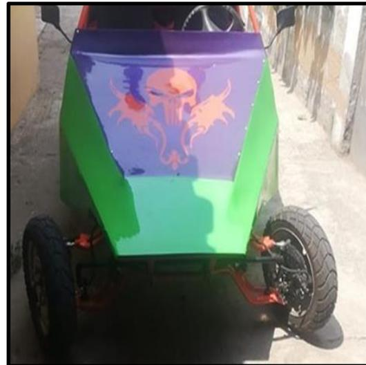
Ángulo de convergencia negativa en la parte derecha del buggy, este ángulo es visible con un peso adicional a la estructura de 350 libras.
