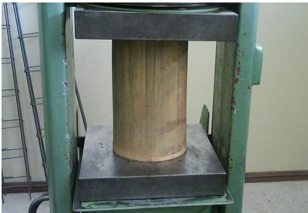
**Fig. 5.7** Máquina de compresión universal y probeta de Bambú, Escuela Politécnica del Ejército, Laboratorio de Resistencia de Materiales
