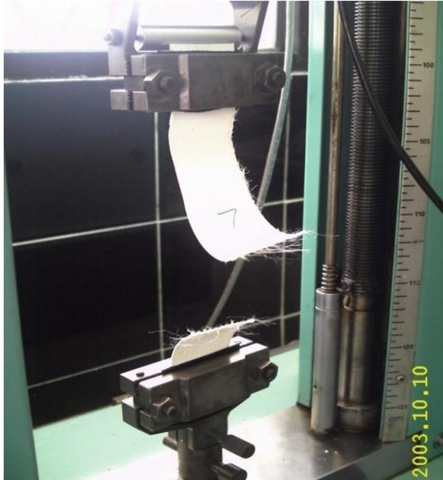
**Fig. 5.36** Tracción membrana, fibras longitudinales y transversales.
