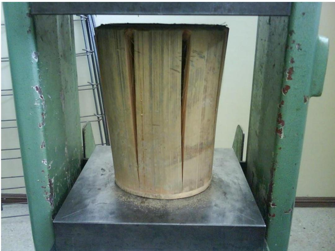
**Fig. 5.12** Cilindro de compresión (nudo-nudo)
