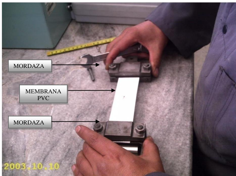
**Fig. 5.34** Colocación de membrana PVC en mordazas
