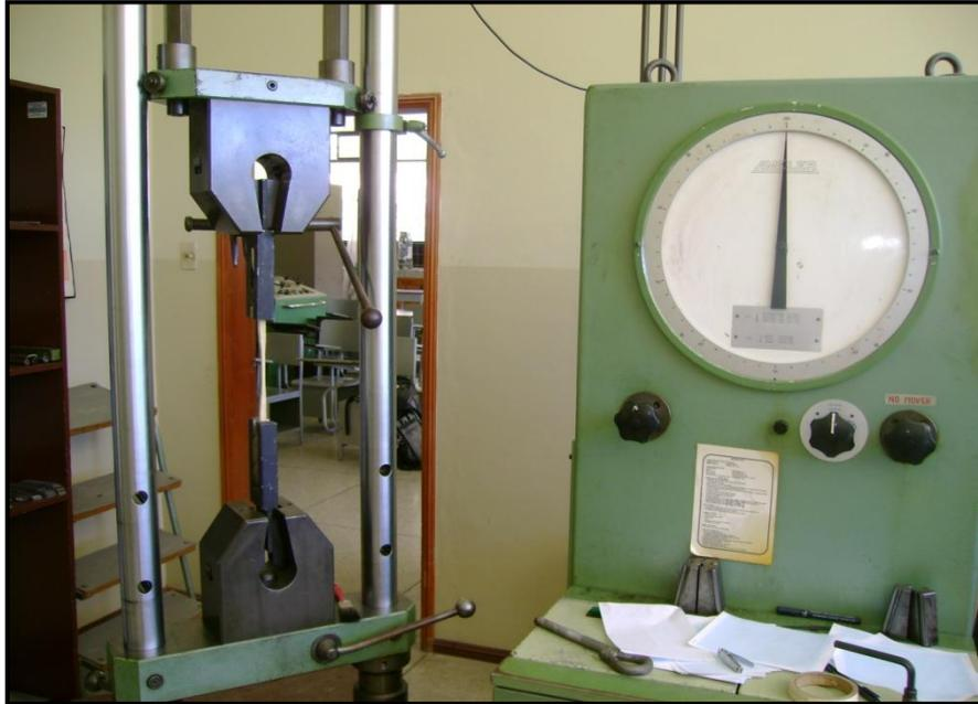
**Fig. 5.1** Máquina universal para ensayo de tracción, Escuela Politécnica del Ejército, Laboratorio de Resistencia de Materiales
