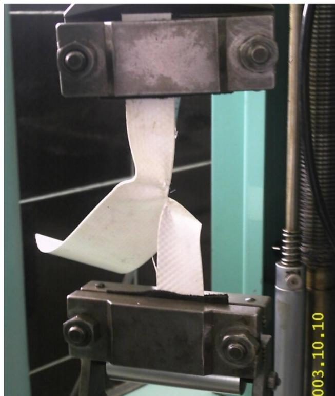
**Fig. 5.37** Desgarre membrana, fibras longitudinales y transversales.
