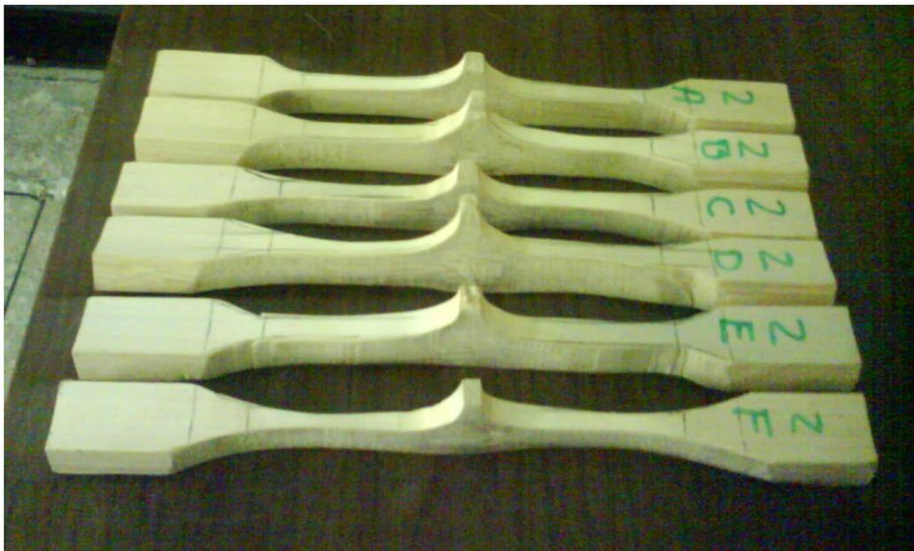
**Fig. 5.6** Probetas para tracción (con nudo en el medio)
