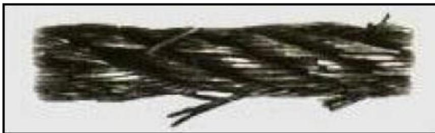
**Fig. 3.7** Fatiga de probeta de Acero
