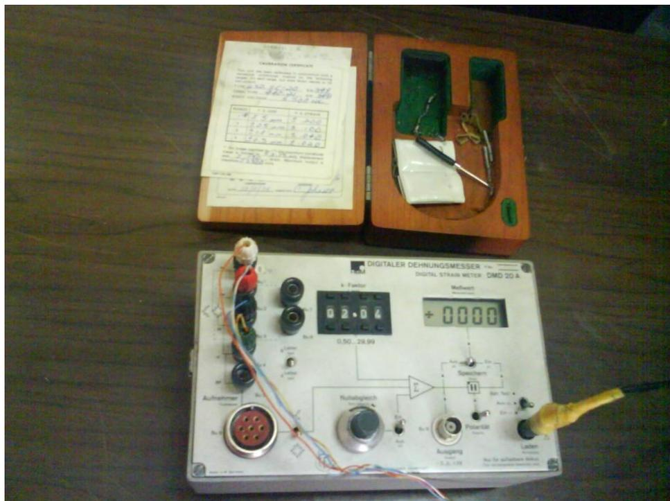
**Fig. 5.3** Máquina de medición de la deformación unitaria
