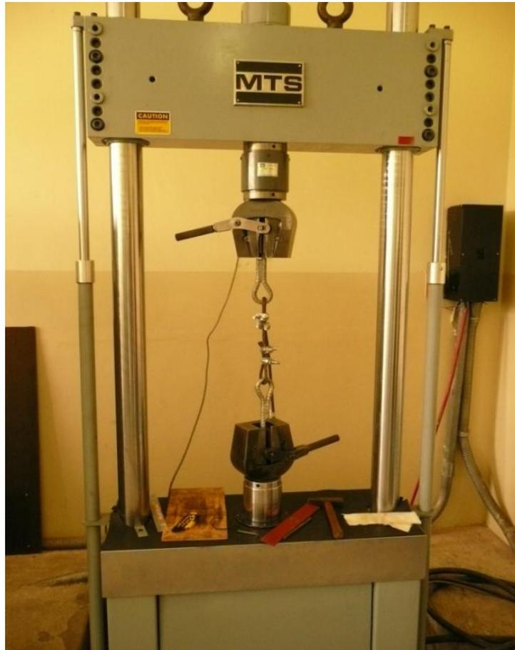
**Fig. 5.20** Máquina de tracción de 25-50 Tn, Escuela Politécnica del Ejército, Laboratorio de Resistencia de Materiales
