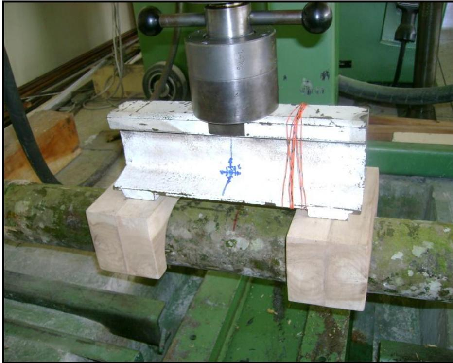
**Fig. 5.17** Viga de repartición de carga (dos puntos)
