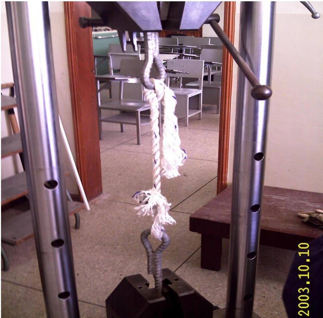
**Fig. 5.24** Máquina universal para ensayo de tracción, Escuela Politécnica del Ejército, Laboratorio de Resistencia de Materiales
