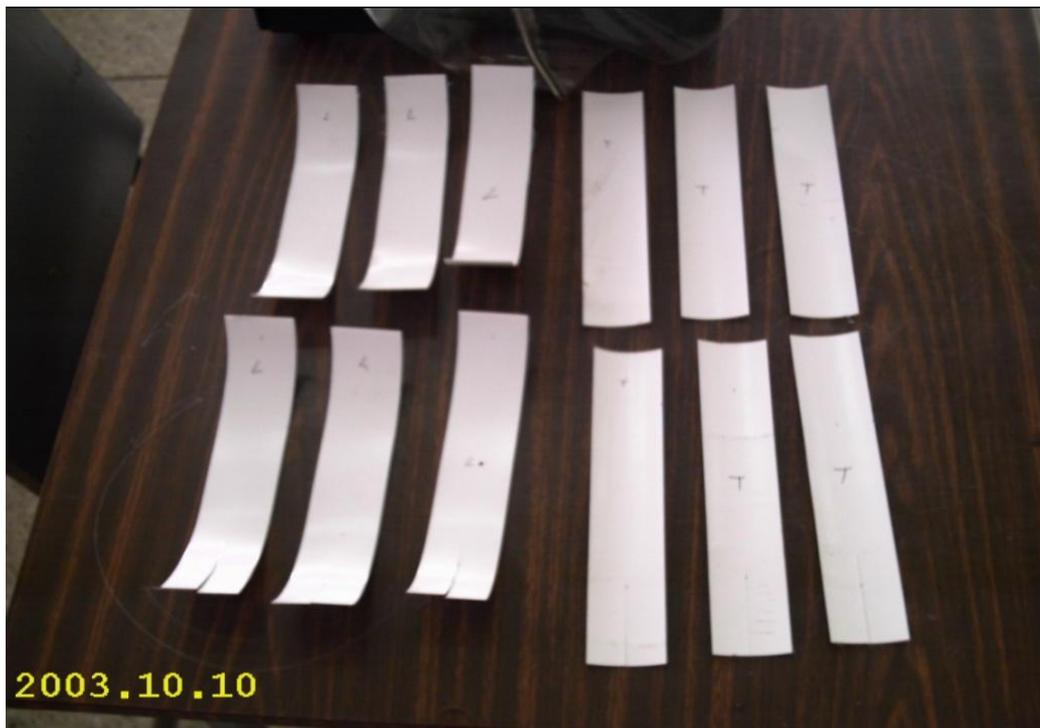
**Fig. 5.32** Probeta ensayos de tracción (fibra transversal y longitudinal).
