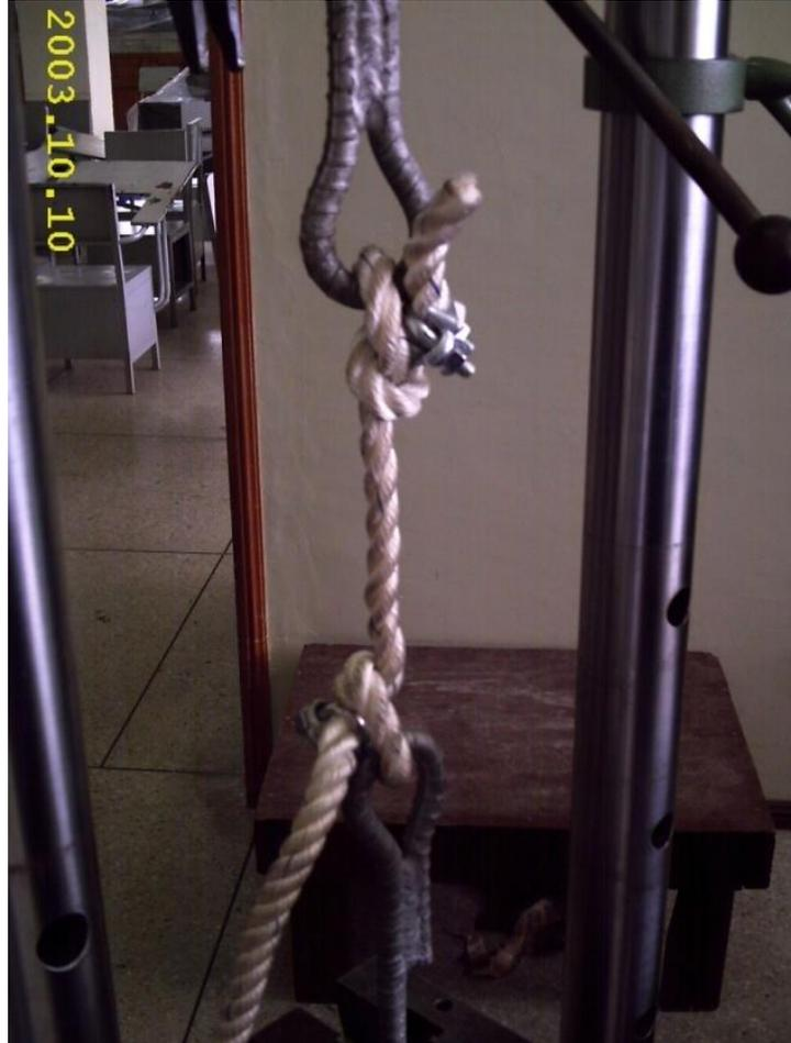
**Fig. 5.25** Probetas de ensayo a tracción.
