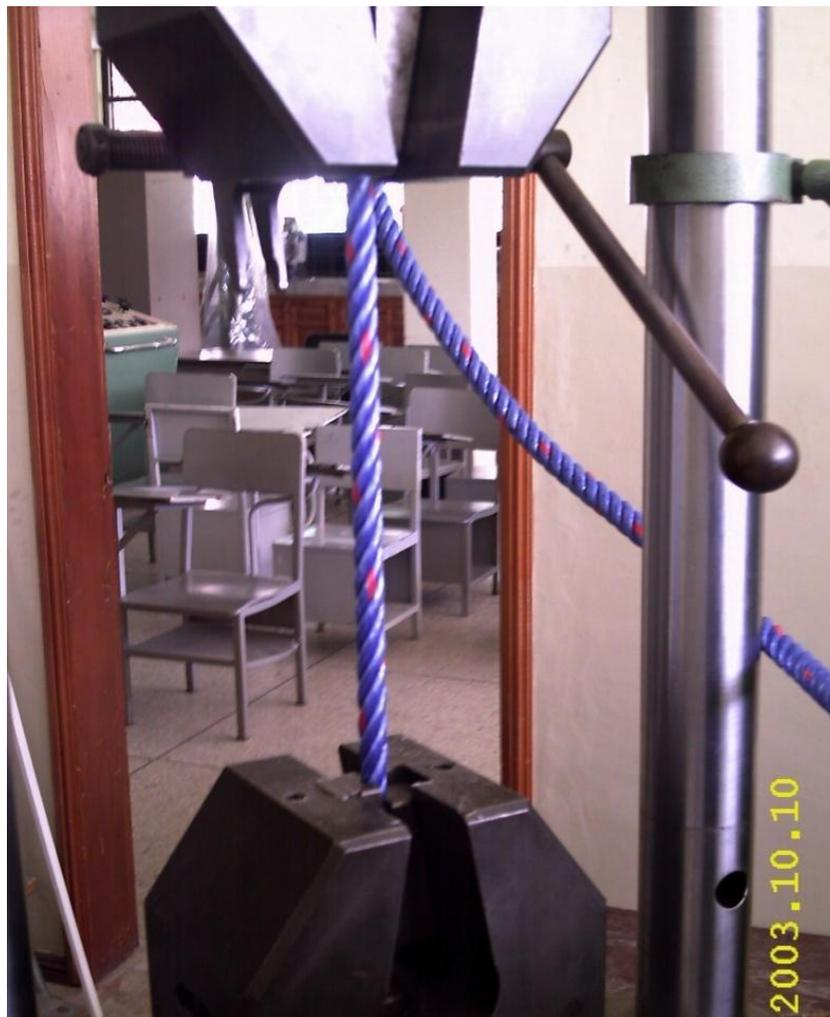
**Fig. 5.28** Probetas para tracción
