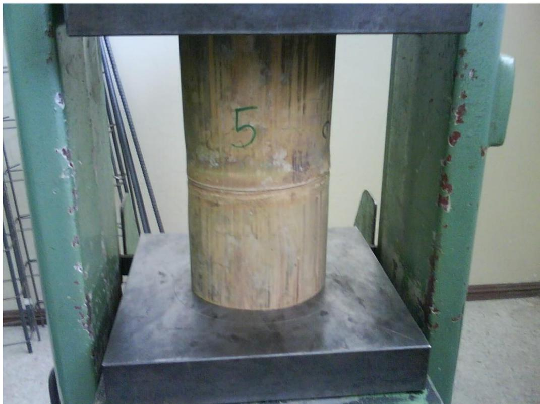
**Fig. 5.8** Cilindros de compresión (hueco-nudo-hueco)
