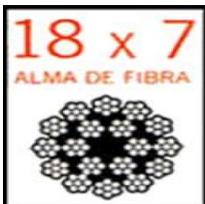
Fig. 3.13 Cables de Acero 18x7 con alma de fibra
