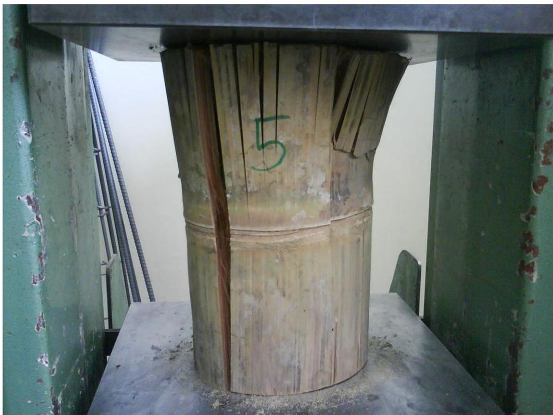
**Fig. 5.10** Cilindro de compresión colapsado (hueco-nudo-hueco)
