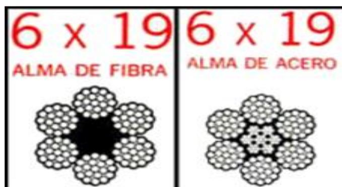
Fig. 3.10 Cables de Acero 6x19 con alma (fibra o acero)
