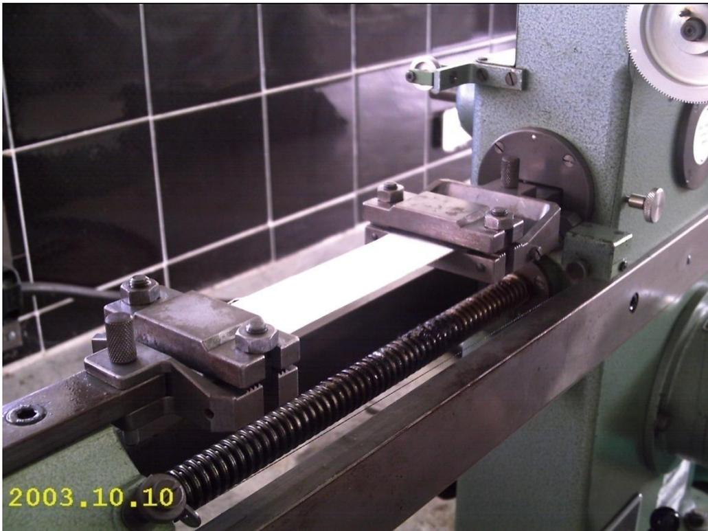
**Fig. 5.30** Máquina de tracción horizontal, capacidad 200Kg.
