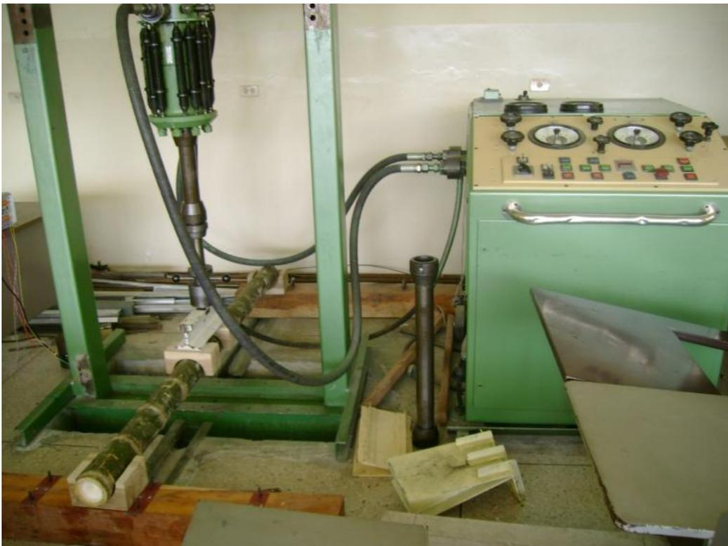
**Fig. 5.14** Maquina de Carga para el ensayo de flexión, Escuela Politécnica del Ejército, Laboratorio de Resistencia de Materiales
