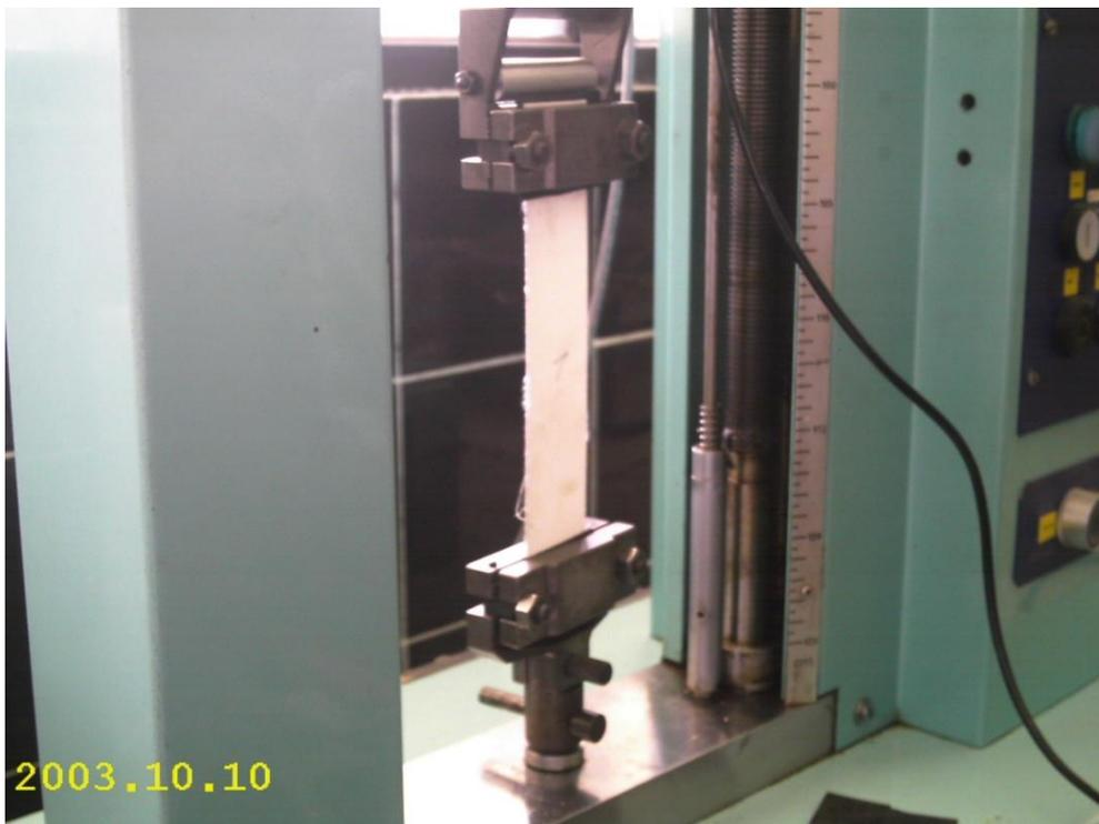
**Fig. 5.31** Máquina de tracción vertical, capacidad 500 Kg.
