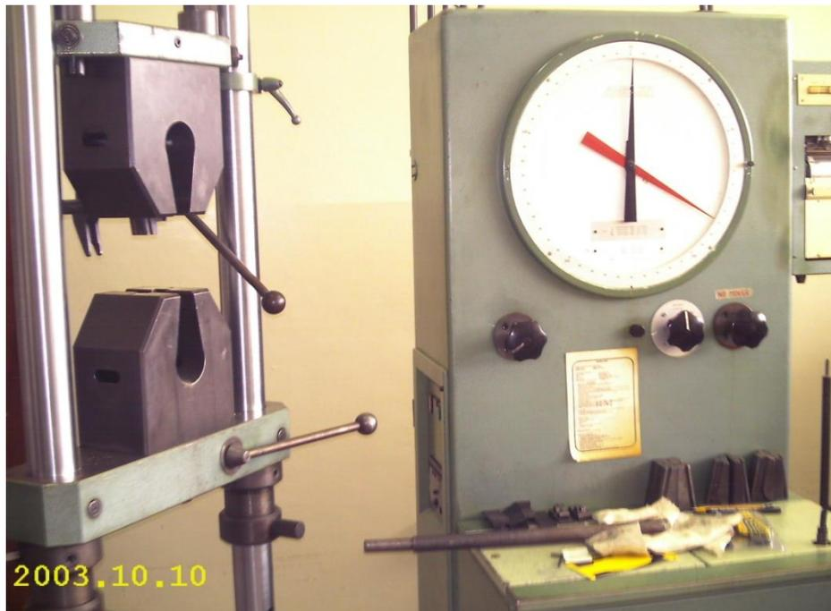
**Fig. 5.19** Máquina para ensayo de tracción 10Tn, Escuela Politécnica del Ejército, Laboratorio de Resistencia de Materiales
