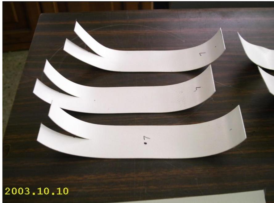
**Fig. 5.33** Probeta ensayos de desgarre (fibra transversal y longitudinal)
