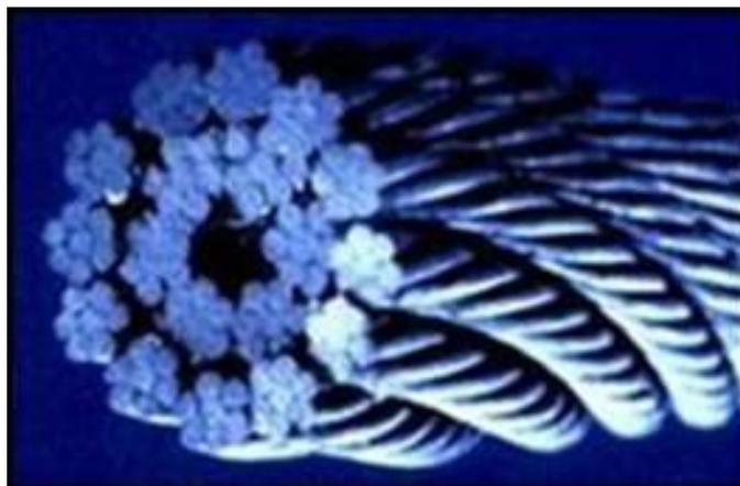
**Fig. 3.9** Modelo de Cable de Acero (alma de yute)
