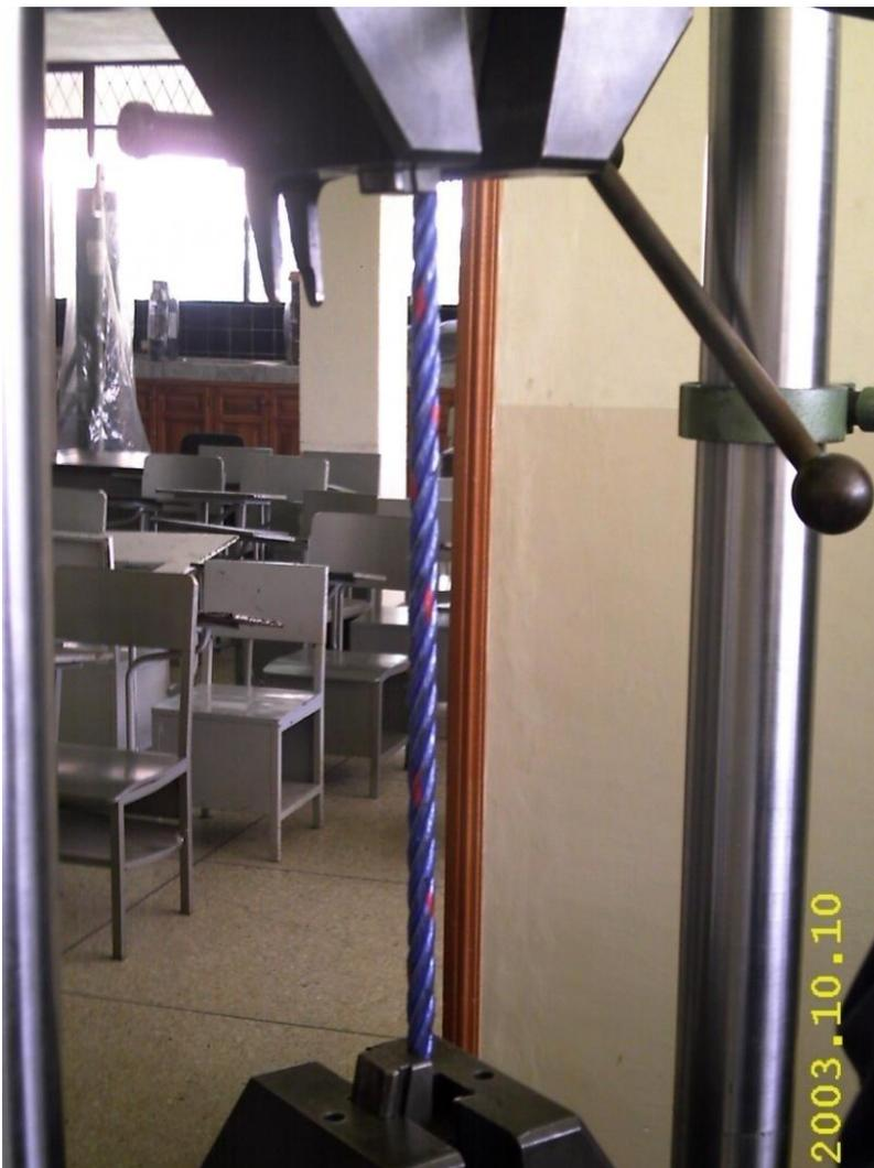
**Fig. 5.27** Máquina universal para ensayo de tracción, Escuela Politécnica del Ejército, Laboratorio de Resistencia de Materiales
