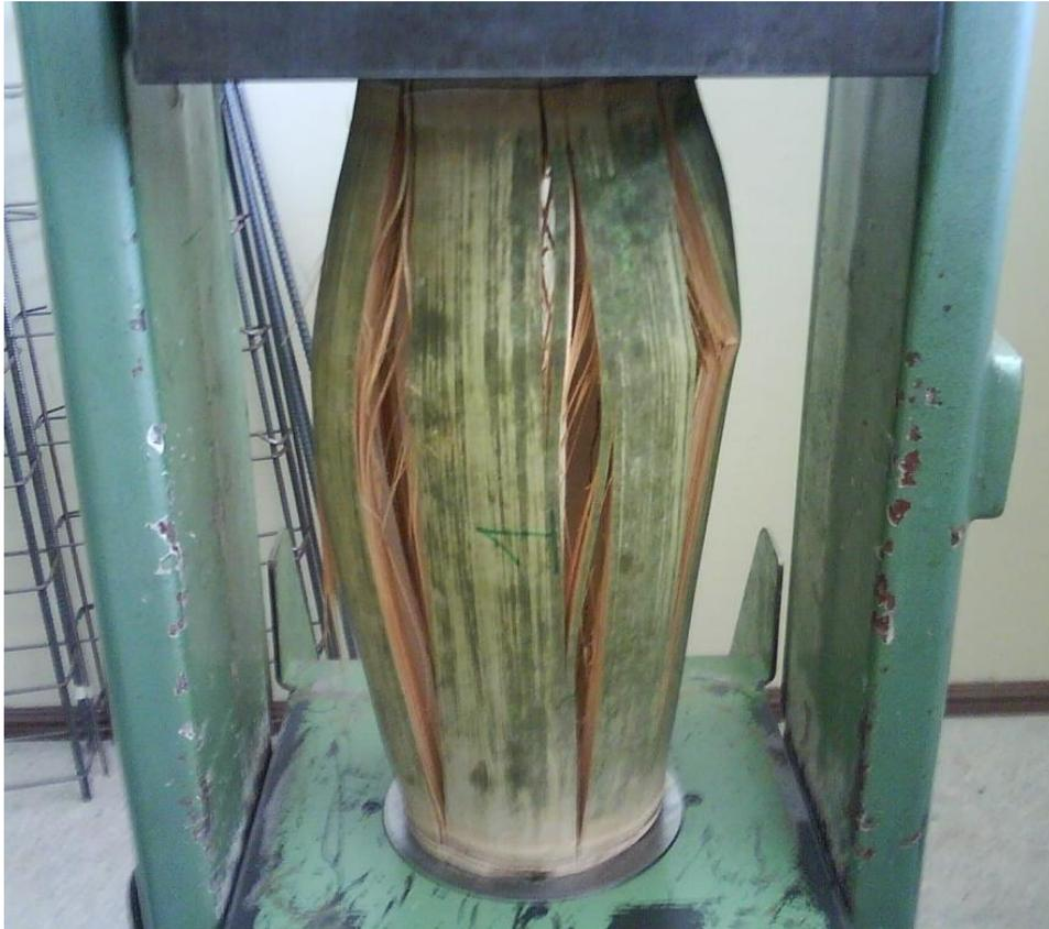
**Fig. 5.13** Cilindro de compresión (nudo-nudo)
