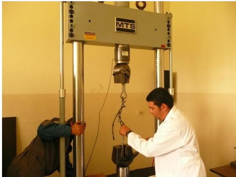
**Fig. 5.21** Probetas para ensayo a tracción
