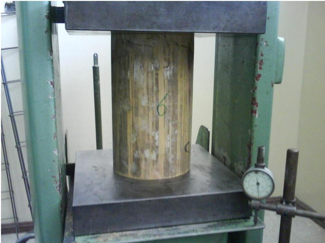
**Fig. 5.9** Cilindro de compresión con Deformímetro (hueco-hueco)
