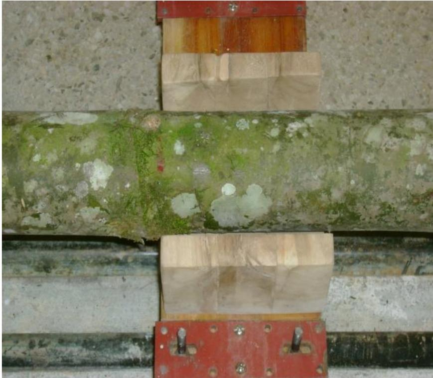
**Fig. 5.15** Dispositivos de madera para los apoyos
