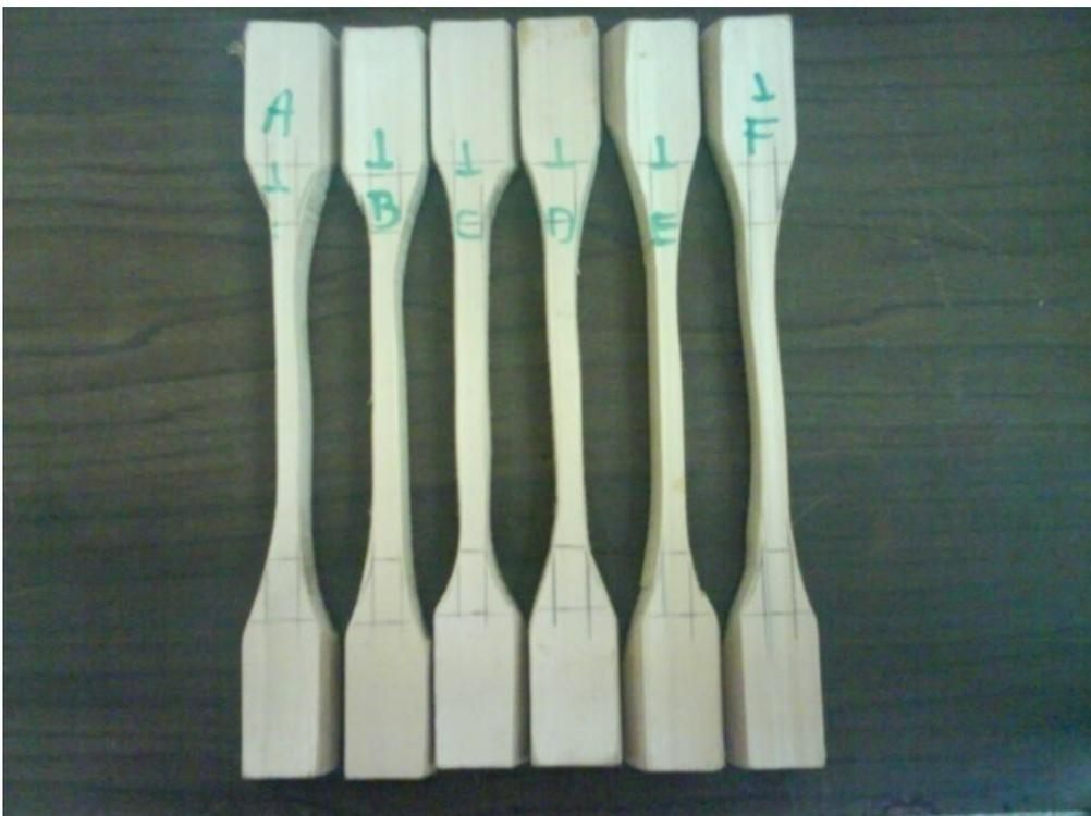
**Fig. 5.5** Probetas para tracción (sin nudo)
