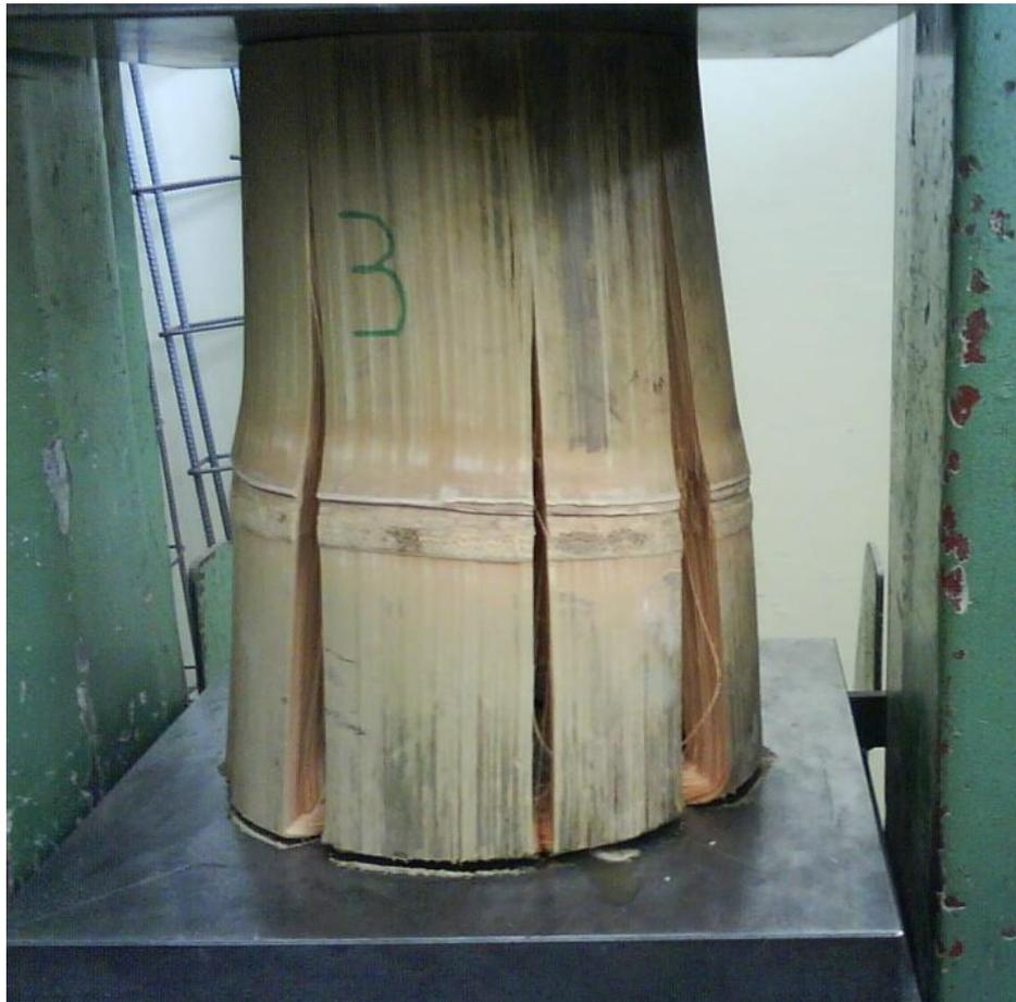
**Fig. 5.11** Cilindros de compresión (hueco-nudo-hueco)
