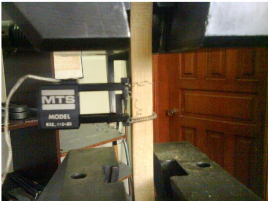
**Fig. 5.2** Deformímetro colocado en la probeta
