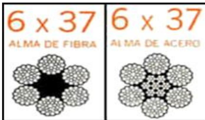
**Fig. 3.11** Cables de Acero 6x37 con alma (fibra o acero)
